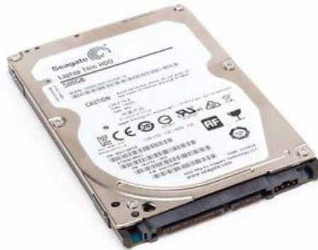
Figure A-11 : Ordinateur d'aide à la maintenance – Lecteur de disque dur de remplacement
