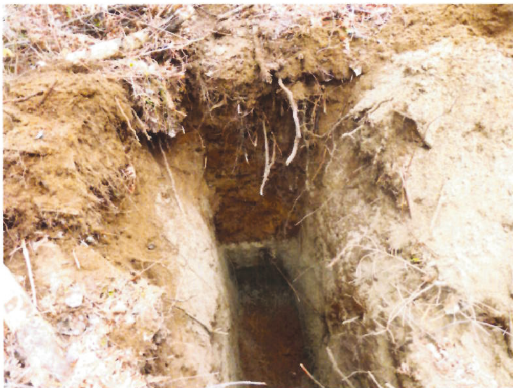
Vue de la stratigraphie des sols au sondage S-6
