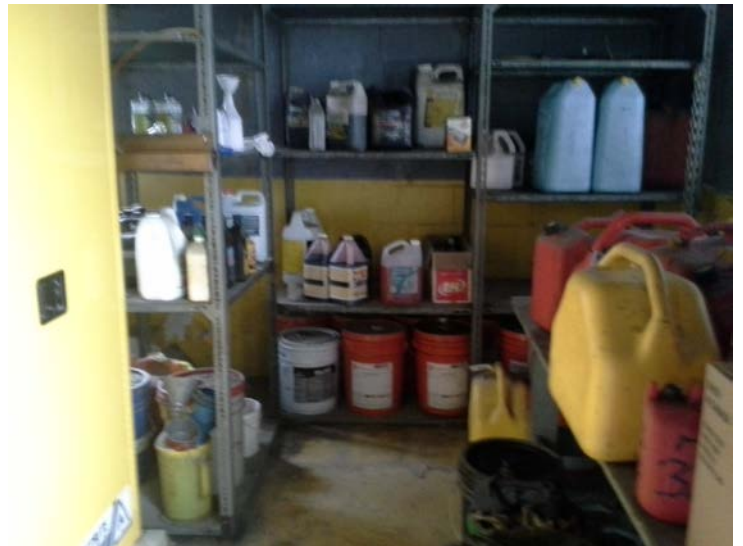
PHOTO 10 Entreposage de matières dangereuses
