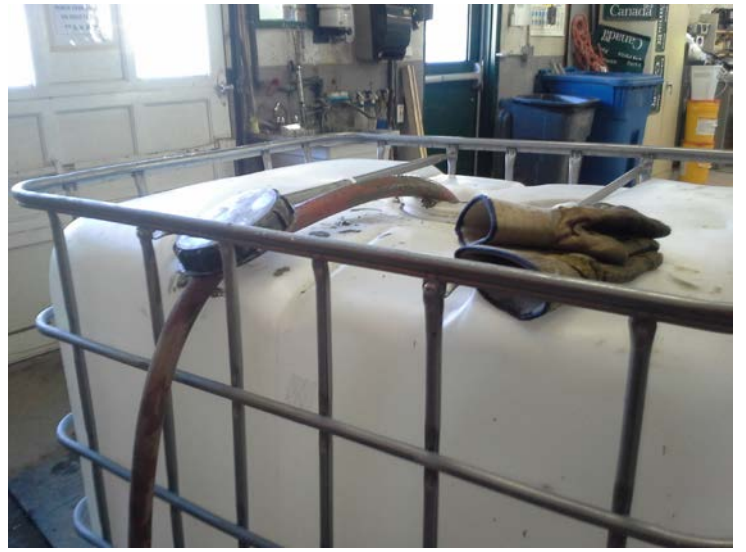
PHOTO 16 Réservoir portatif de 1 000 l dans lequel l'eau de provenant des puits d'observation a été récupérée
