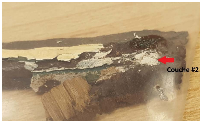
Photo 8 – Enduit blanc-beige, peint en vert, situé sous le mastic brun, extérieur du bâtiment. La peinture verte présente sur les portes et les cadrages de bois extérieurs contient du plomb. La peinture était en bonne état.
