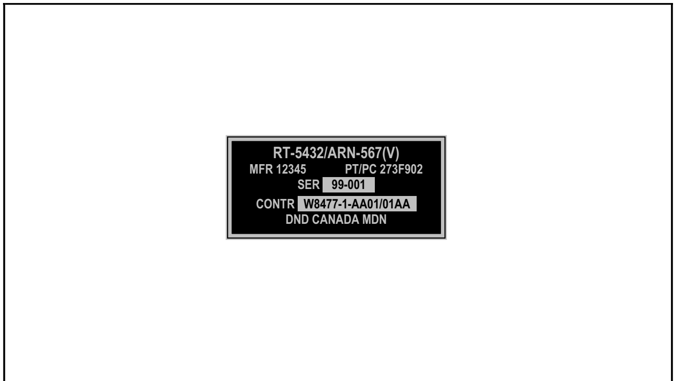
Figure 3-2-3 Abridged Identification Plate for Items Assigned a Military Nomenclature with Minimal Space Available for Mounting Figure 3-2-3 Plaque d'identification à contenu abrégé pour articles à nomenclature militaire lorsque l'espace de montage est restreint
