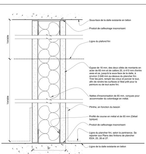
2 Coupe - Cloison d'intérieur du locataire - Type 2 - D'une dalle à l'autre
