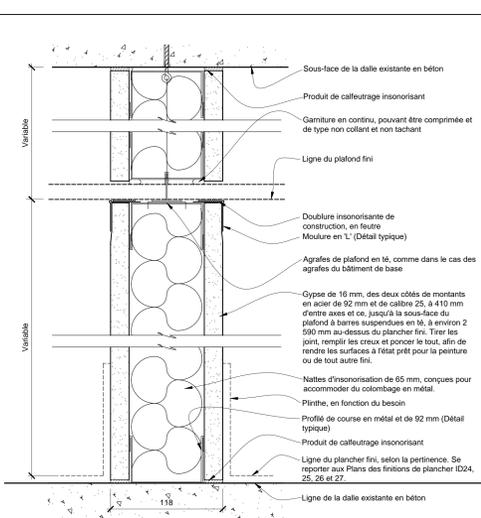
1 Coupe - Cloison d'intérieur du locataire - Type 1 - Sous-face du plafond suspendu et à barres en té et de type aménagé avec une barrière de plénum
