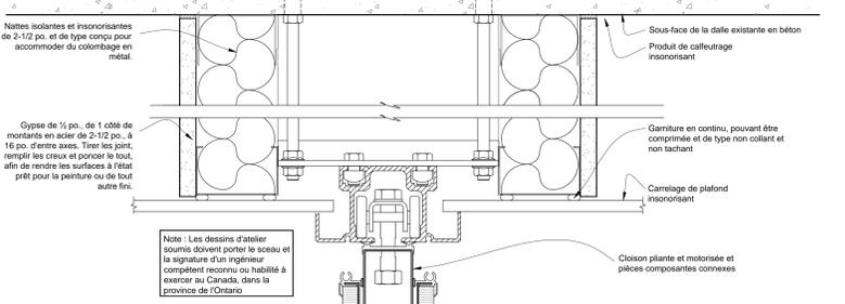
8 Coupe - Séparation de plénum à l'emplacement d'une cloison amovible et motorisée
