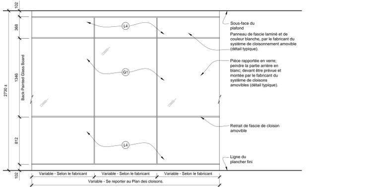
**6** Élévation - Mur démontable typique et assorti de panneaux vitrés
