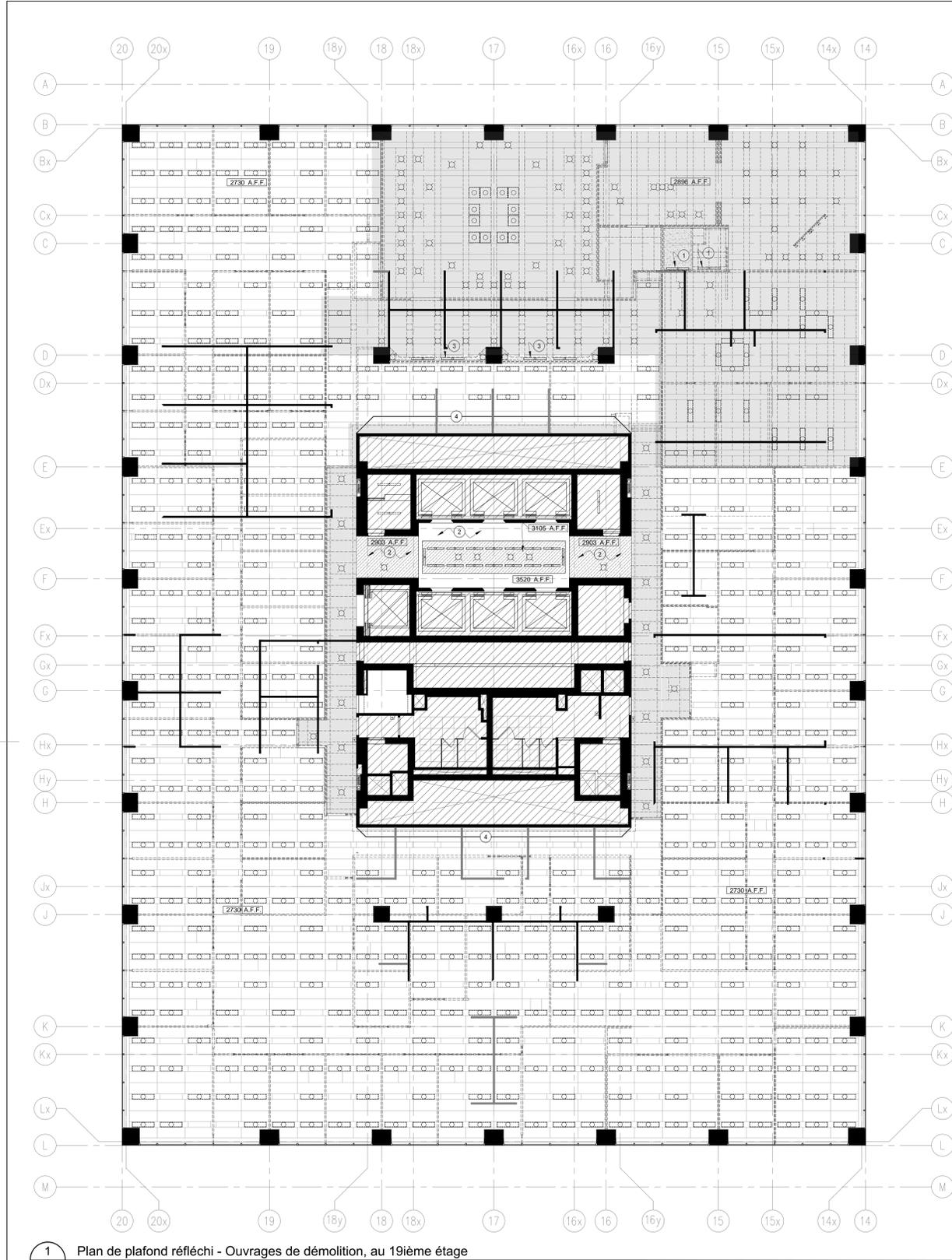
1 Plan de plafond réfléchissant - Ouvrages de démolition, au 19<sup>ème</sup> étage
