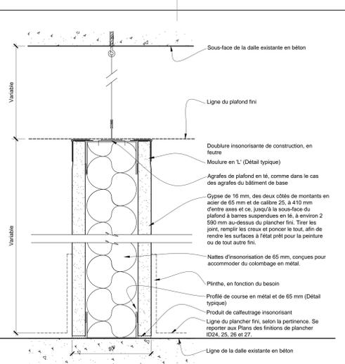
3 Coupe - Cloison d'intérieur du locataire - Type 8 - Sous-face du plafond suspendu et à barres en té
