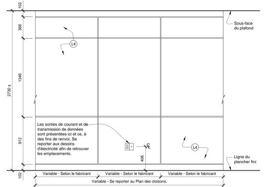
**5** Élévation - Mur démontable typique et à l'état rempli
