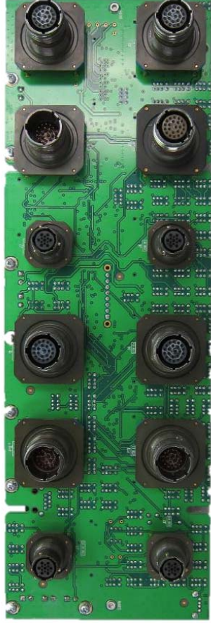
Panneau avant du DCCS – Vue de la face externe
