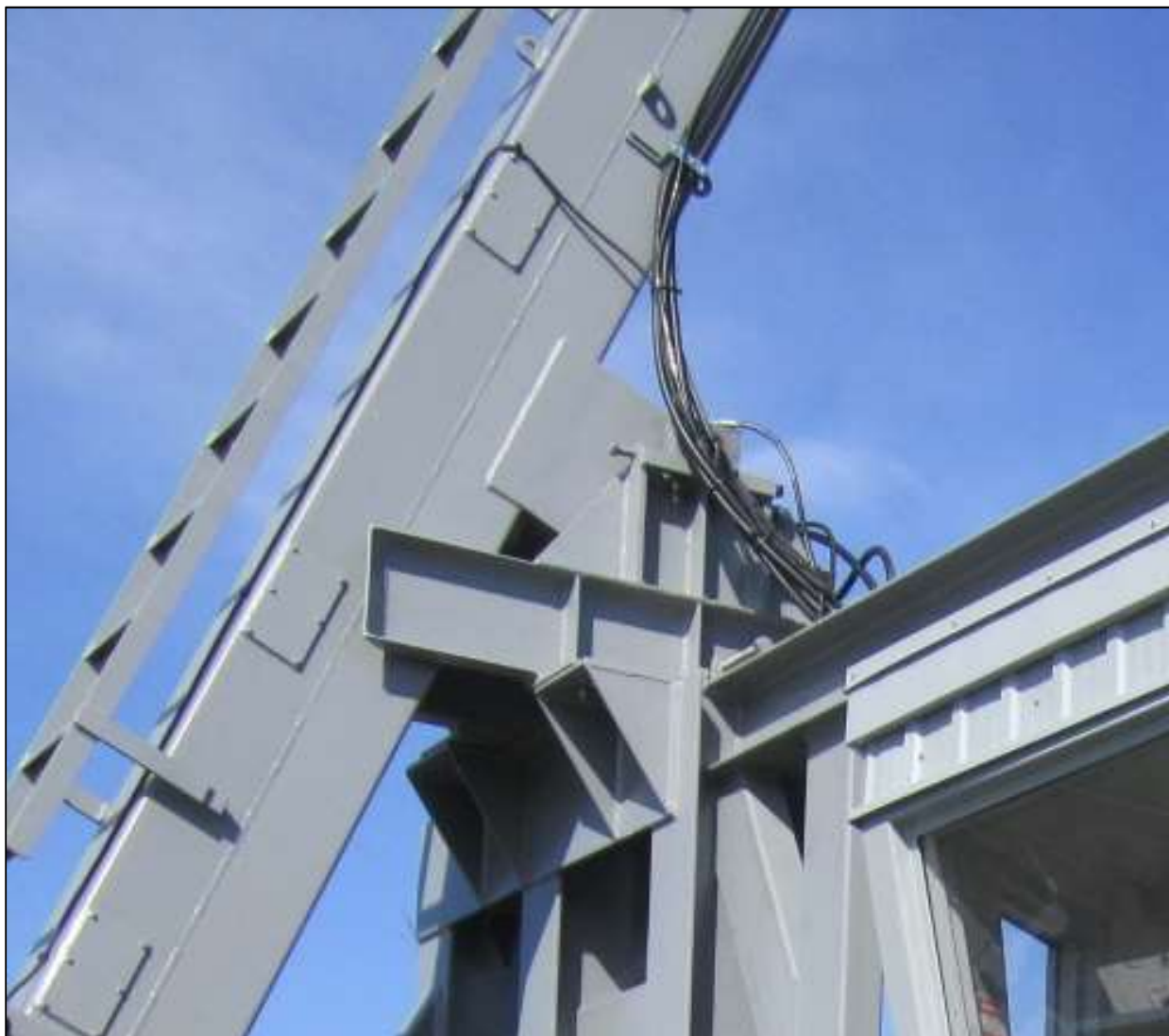
Figure 11 – Détails du raccordement entre la flèche et le châssis. Il s'agit ici d'un détail de la flèche qui présente des problèmes.
