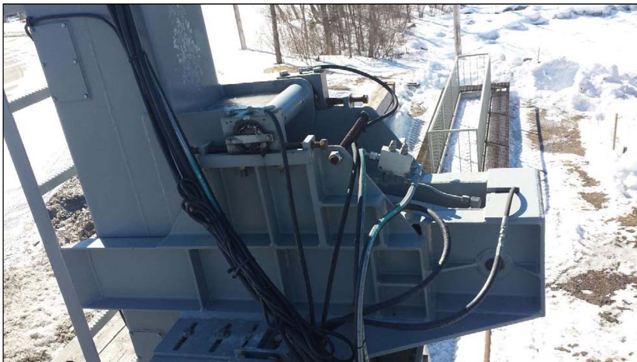
Figure 12 – Raccordement entre la flèche et le châssis du lève-poutrelles. Photo : Garage PEM Barrette, 2015.
