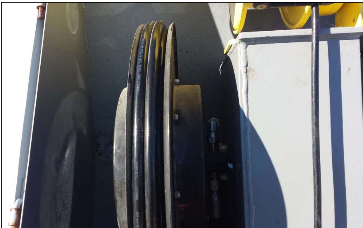
Figure 15 – Dévidoir de boyau hydraulique sur le dessus de la flèche. Dévidoir de câble électrique dans le coin supérieur droit sur la photo. Veuillez également noter les valves au centre de la photo. Photo : Garage PEM Barrette, 2015.
