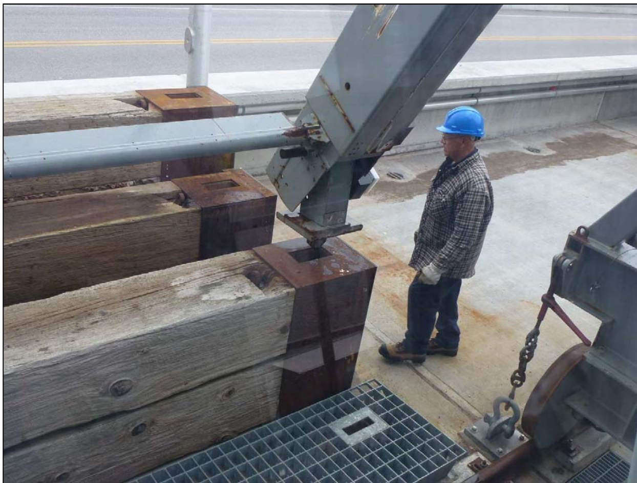
Figure 9 – Le lève-poutrelles (machine de l'Ontario, mais celle du barrage du Québec est comparable) se prépare à cueillir une poutrelle du tablier.
