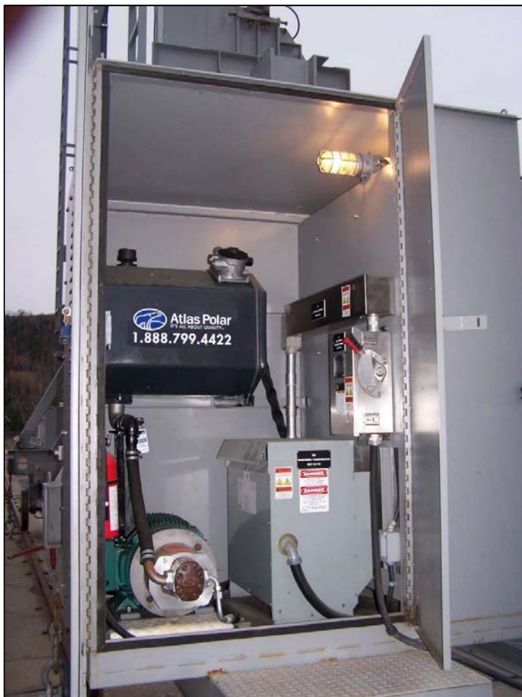
Figure 20 – Intérieur de l'armoire d'alimentation hydraulique.
