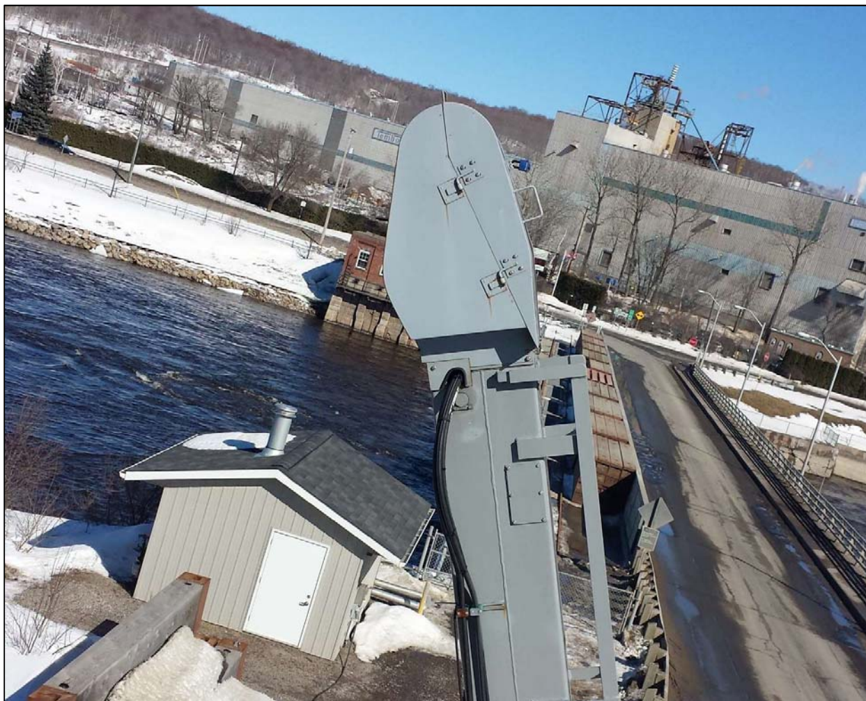
Figure 14 – Détails du logement sur le dessus des flèches où l'on trouve le dévidoir de boyau hydraulique et le dévidoir de câble électrique. Photo : Garage PEM Barrette, 2015.
