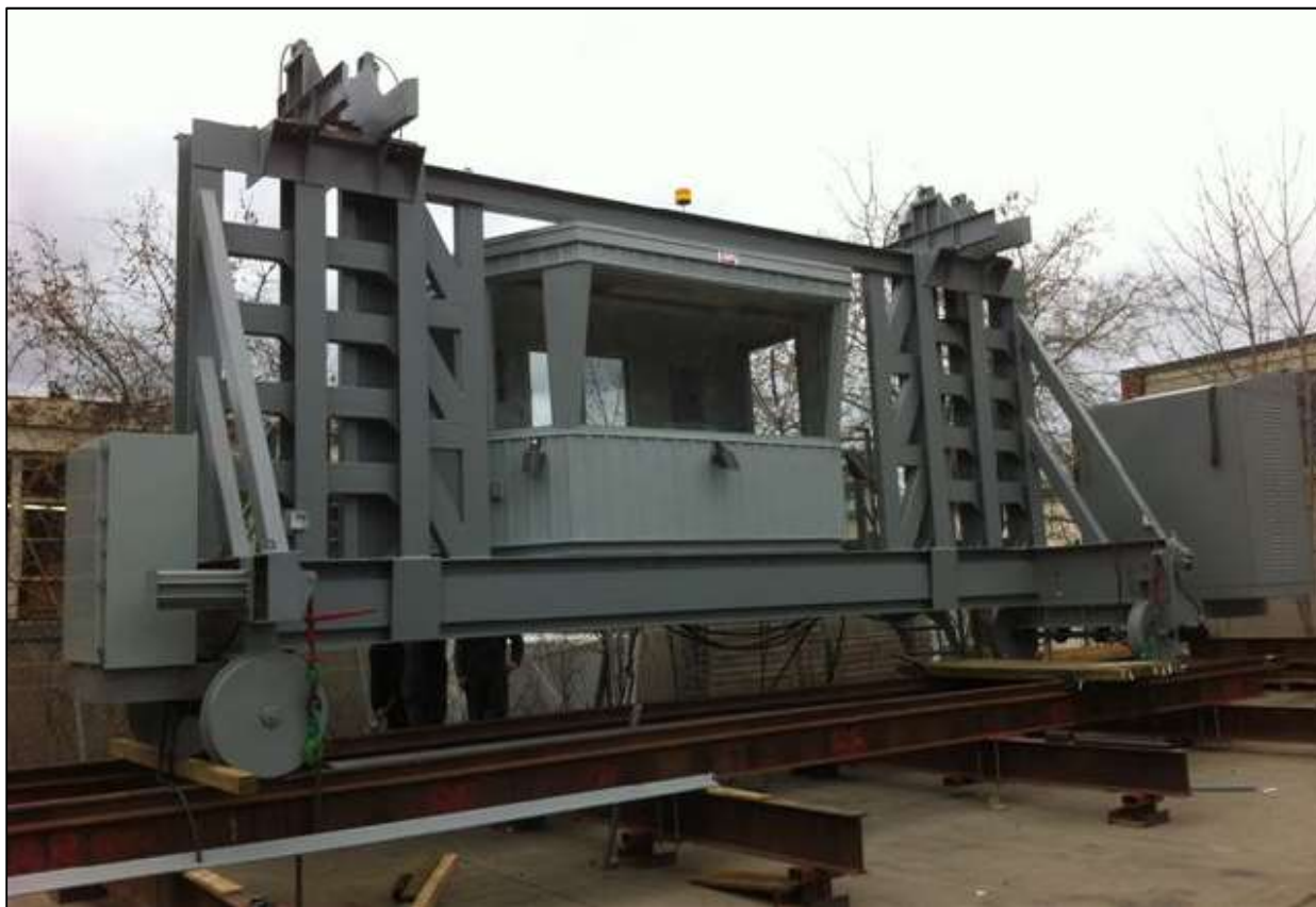
Figure 17 – Châssis du lève-poutrelles en cours de construction, avant l'installation des flèches. Photo : J. L. Richards 2011.
