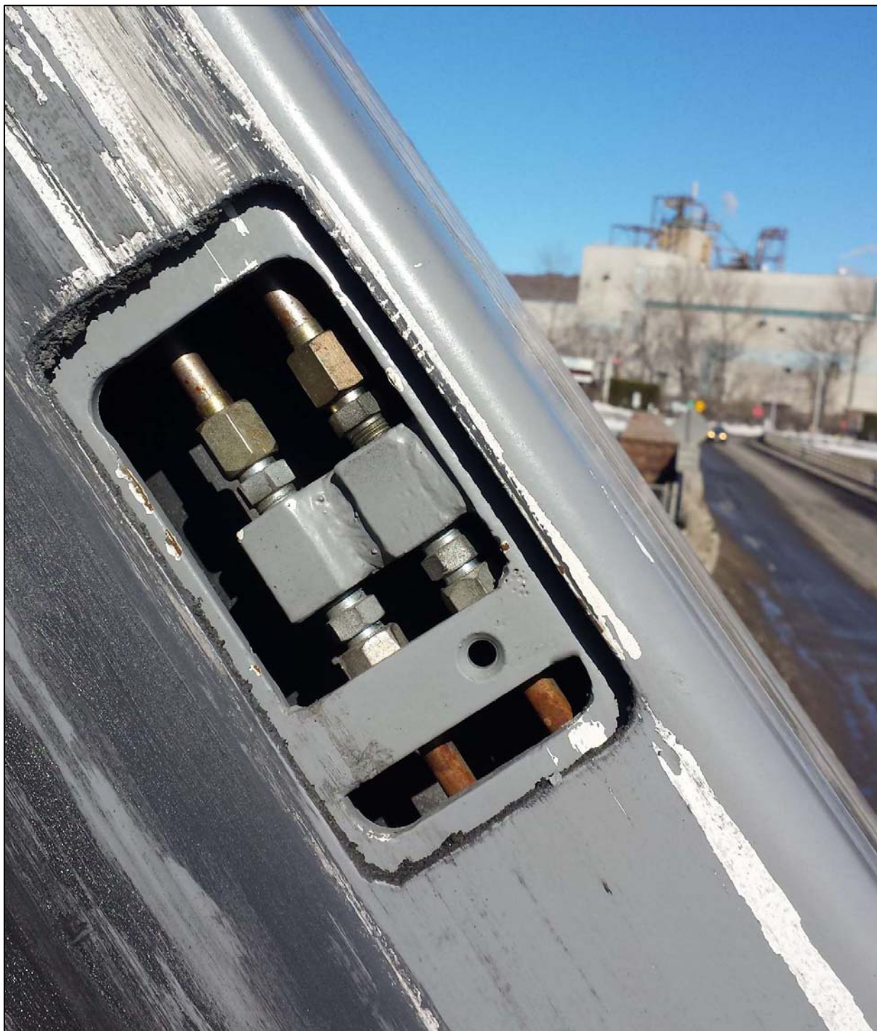
Figure 16 – Raccords hydrauliques à l'intérieur de la flèche. Photo : Garage PEM Barrette, 2015.
