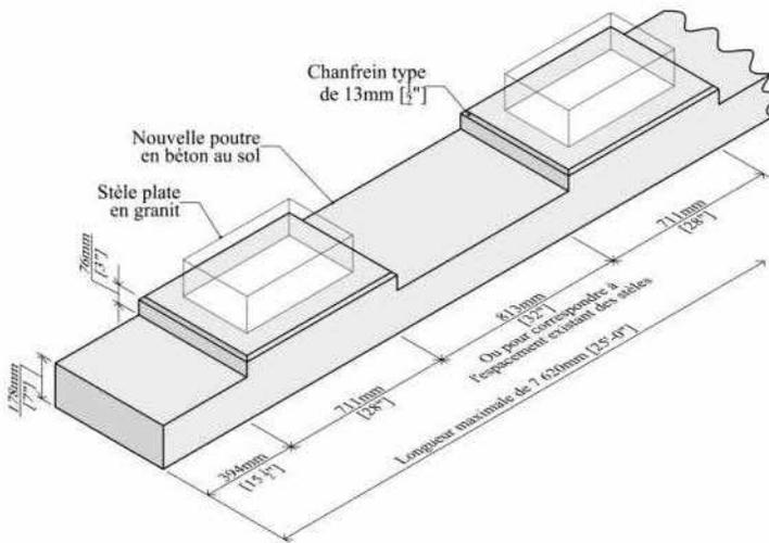
**Figure 4.4f (ii) :** Poutre de fondation reposant sur le sol pour stèles plates et stèles commandées spécialement – poutre enterrée, stèle surélevée au-dessus du gazon. [C. Chandler, DCP, 2004].
