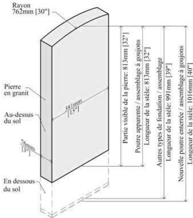
**Figure 4.1e :** Forme de la stèle en granit pour civils d'ACC. [C. Chandler, DCP, 2004]
