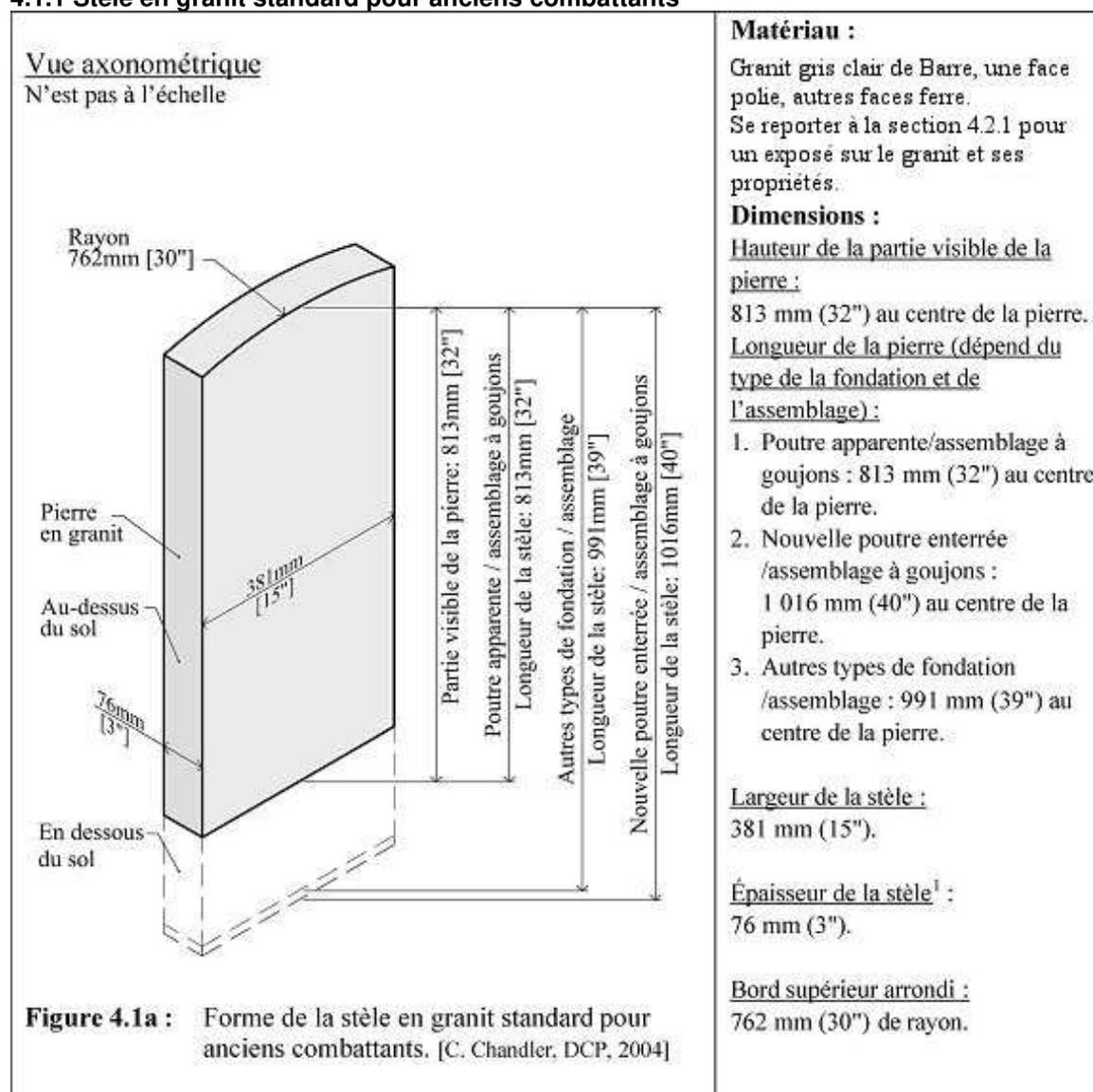
**Figure 4.1a :** Forme de la stèle en granit standard pour anciens combattants. [C. Chandler, DCP, 2004]
