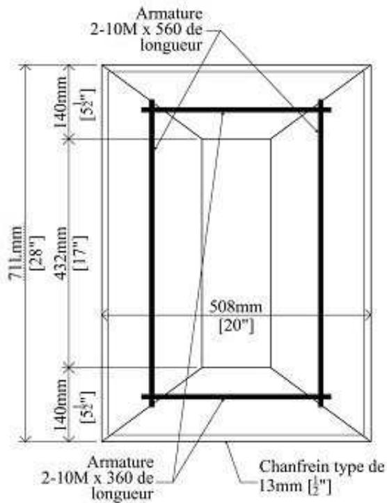
Figure 4.4a (iii) : Fondation simple pour stèle. [C. Chandler, DCP, 2004].
