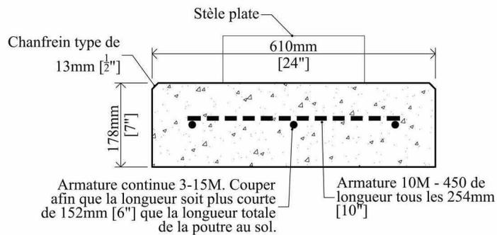
**Figure 4.4e (ii) :** Poutre de fondation au sol pour stèles plates multiples et stèles commandées spécialement – poutre apparente.
