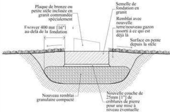
Figure 4.4c (ii) : Fondation simple pour stèle commandée spécialement. [C. Chandler, DCP, 2004].
