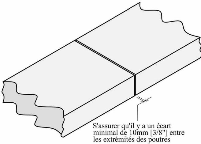
**Figure 4.4d (iii) :** Poutre au sol pour stèles multiples.
