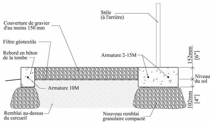
**Figure 4.5a (iii) :** Détails de la section longitudinale d'une tombe couverte d'un matériau non biologique. [C. Chandler, DCP, 2004]
