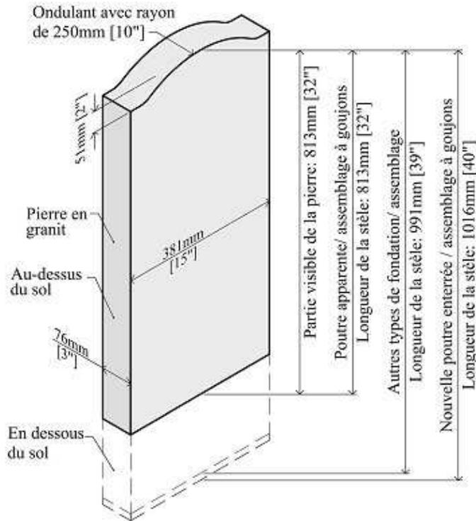
**Figure 4.1h :** Forme de la stèle en granit pour employés du MDN. [C. Chandler, DCP, 2004]
