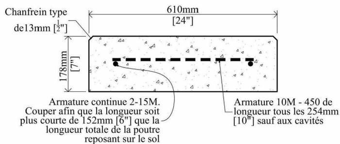
**Figure 4.4d (ii) :** Poutre au sol pour stèles multiples.
