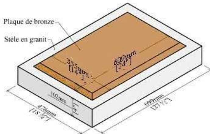
**Figure 4.1d :** Forme de la stèle plate avec plaque de bronze (commande spéciale) pour anciens combattants. [C. Chandler, DCP, 2004]
