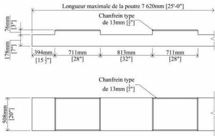
**Figure 4.4f (iii) :** Poutre de fondation reposant sur le sol pour stèles plates et stèles commandées spécialement – poutre enterrée, stèle surélevée au-dessus du gazon.
