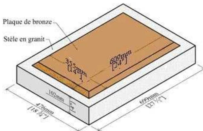
**Figure 4.1j :** Forme de la stèle plate avec plaque de bronze pour employés du MDN. [C. Chandler, DCP, 2004]
