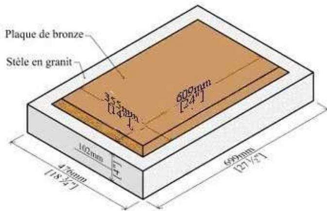
**Figure 4.1g :** Forme de la stèle plate avec plaque de bronze pour civils d'ACC. [C. Chandler, DCP, 2004]
