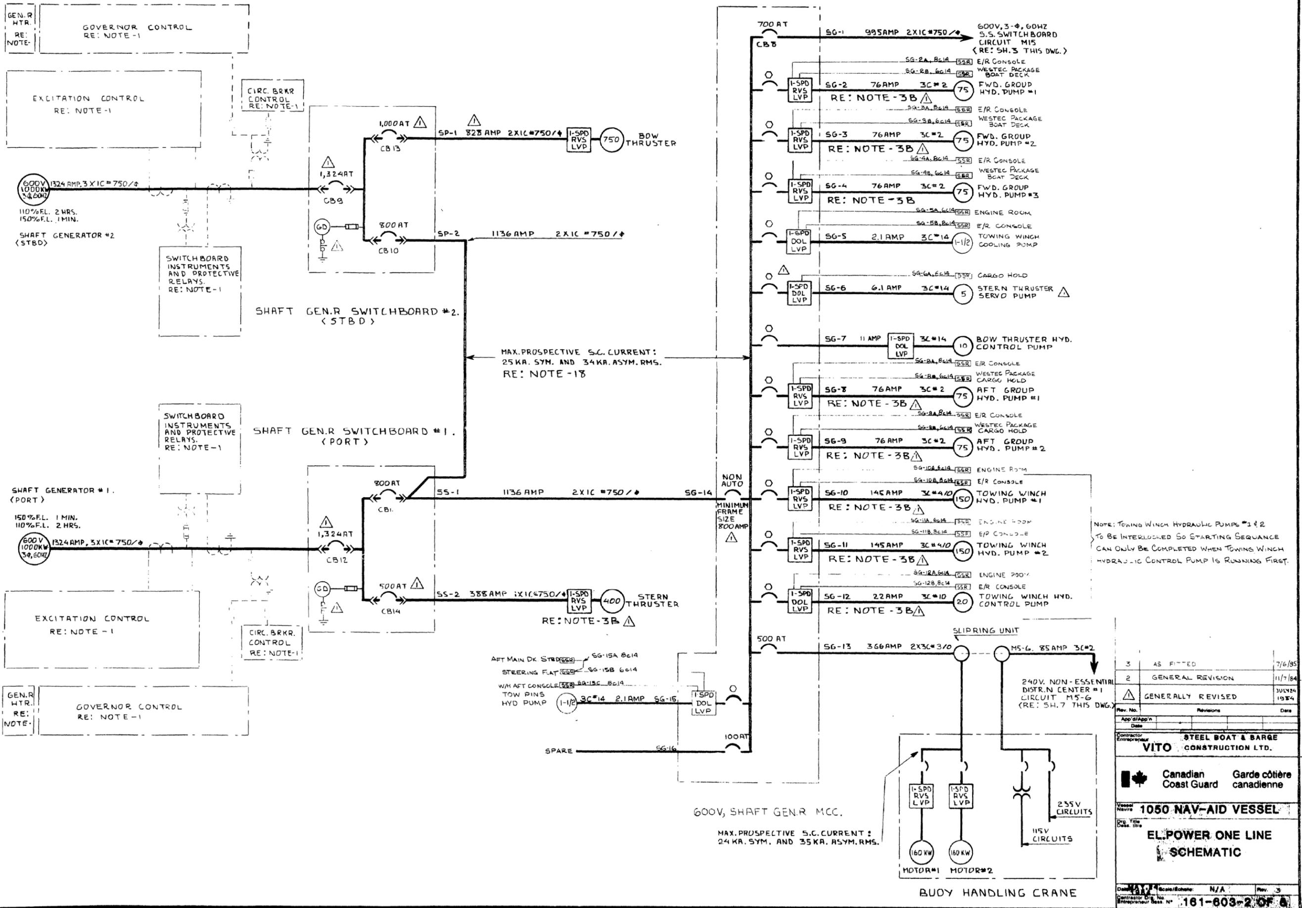
NOTE: TOWING WINCH HYDRAULIC PUMPS #1 & 2 TO BE INTERLOCKED SO STARTING SEQUENCE CAN ONLY BE COMPLETED WHEN TOWING WINCH HYDRAULIC CONTROL PUMP IS RUNNING FIRST.
