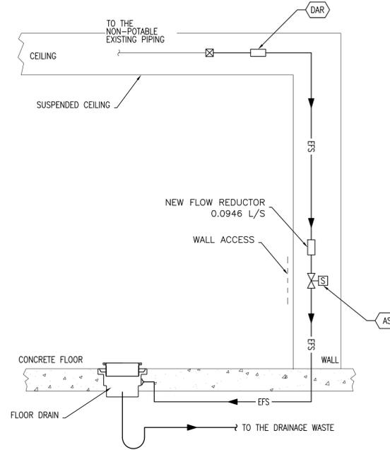
**TYPICAL INSTALLATION OF A TRAP-PRIMER**
