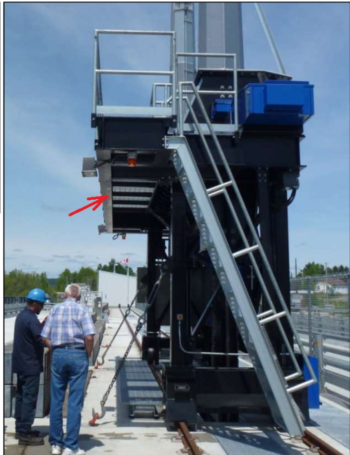
Figure 4 : Lève-poutrelle. La flèche indique la poutre à laquelle les rails doivent être fixés.
