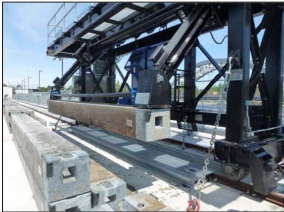
Figure 3 : Lève-poutrelle en fonction.
