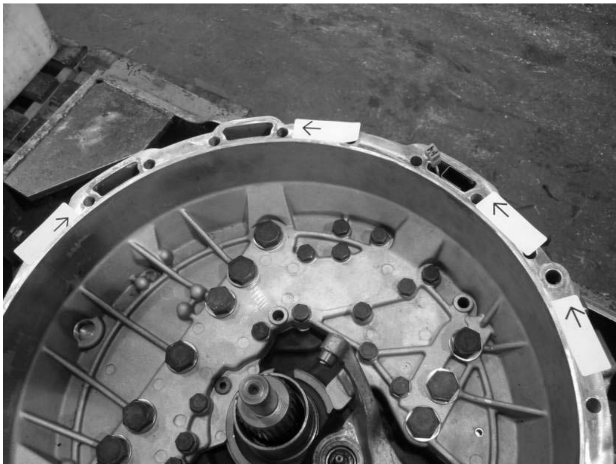
Figure 1 : Carter d'embrayage et carter d'appariement (non illustré) – Application de scellant à rebords Loctite 574
