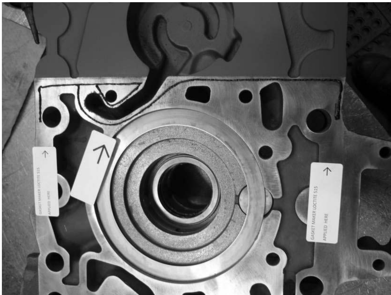
Figure 3 : Carter de branchement – Application de scellant pour rebords Loctite 515
