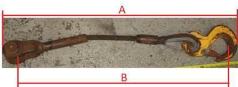
1 mètre est indiqué comme étant la longueur totale, mesurez-vous le point d'appui sur le point d'appui? La longueur B correspond au point de relèvement au point de relèvement, qui est la longueur de mesure standard dans l'industrie. Nous devons savoir comment l'ensemble a été mesuré pour obtenir la bonne longueur, car il n'y a pas de ruban à mesurer sur la photo.
