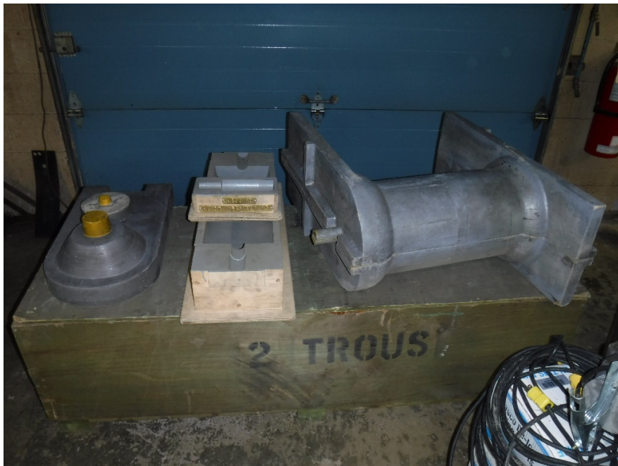
Photo n° 20 – Moules de l'APC pour pivot inférieur et pivot supérieur des portes d'écluse (photo APC).
