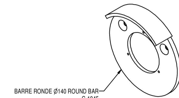
BARRE RONDE Ø140 ROUND BAR C-1045 PLAQUER ZINC ET PEINTURER NOIR SELON DEVIS PLATE ZINC AND PAINT BLACK AS SPECIFICATION
