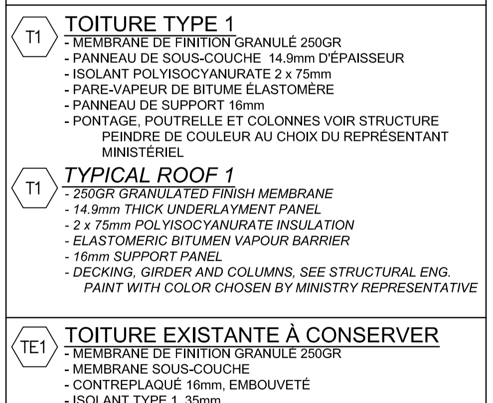
COMPOSITIONS TYPES TYPICAL COMPOSITIONS TE1 TOITURE EXISTANTE À CONSERVER - MEMBRANE DE FINITION GRANULÉ 250GR - MEMBRANE SOUS-COUCHE - CONTREPLAQUÉ 16mm, EMBOUVETÉ - ISOLANT TYPE 1, 35mm - ISOLANT TYPE 1, 102mm (TASSEAUX 64x115mm @ 600mm c/c) - PARE-VAPEUR - PLACOPÂTRE TYPE X 16mm - PONTAGE D'ACIER, VOIR INGÉNIEUR - STRUCTURE D'ACIER, VOIR INGÉNIEUR
