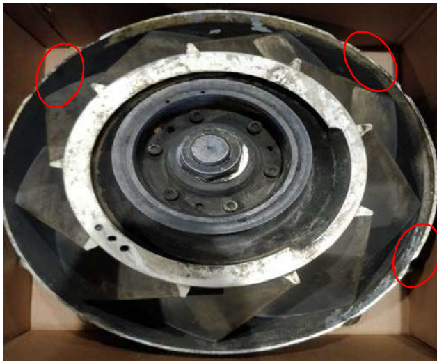
Figure 1 et 2 – Dommages typiques au boîtier, aux ailettes et aux cannelures
