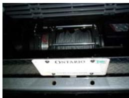
77. Les commandes du pare-chocs hydraulique et du treuil doivent se trouver sur une console plafond dans le compartiment du conducteur. Il ne doit pas y avoir de commandes extérieures pour ces fonctions.
