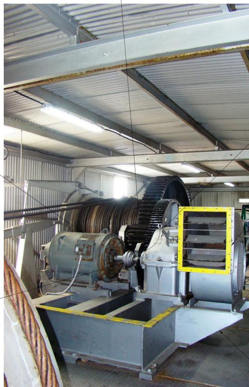
DÉMANTELER MOTEUR ET FREIN EXISTANT DISMANTLE EXISTING MOTOR AND BRAKE
