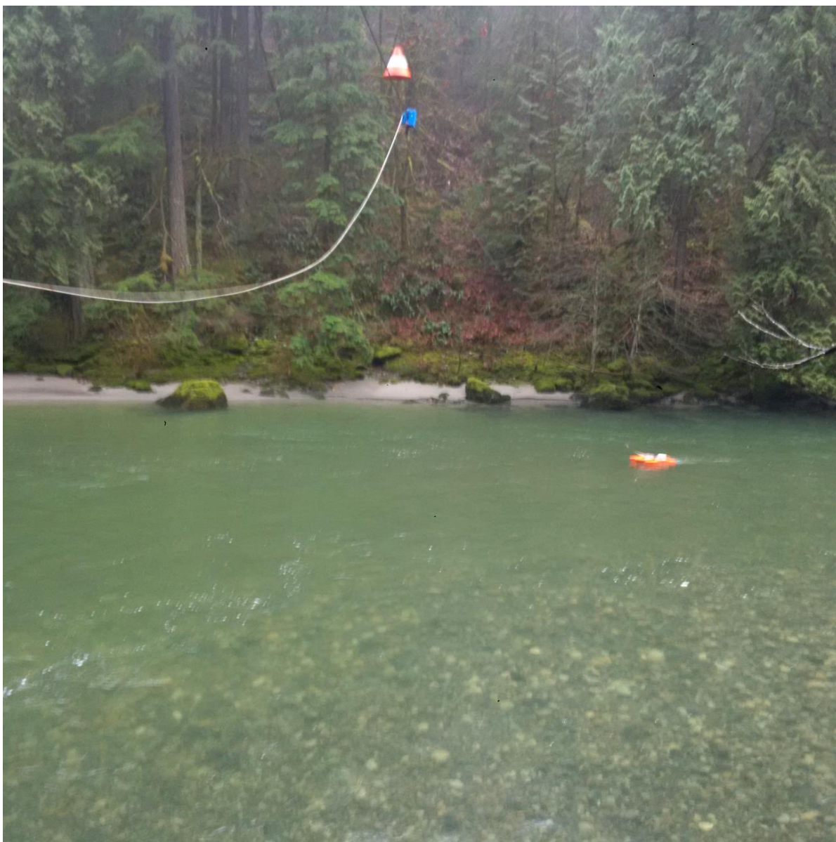
Figure 1: Téléphérique adapté pour passer d'un téléphérique avec personnel à un téléphérique commandé à distance depuis la rive avec un système de déplacement transversal par câble.
