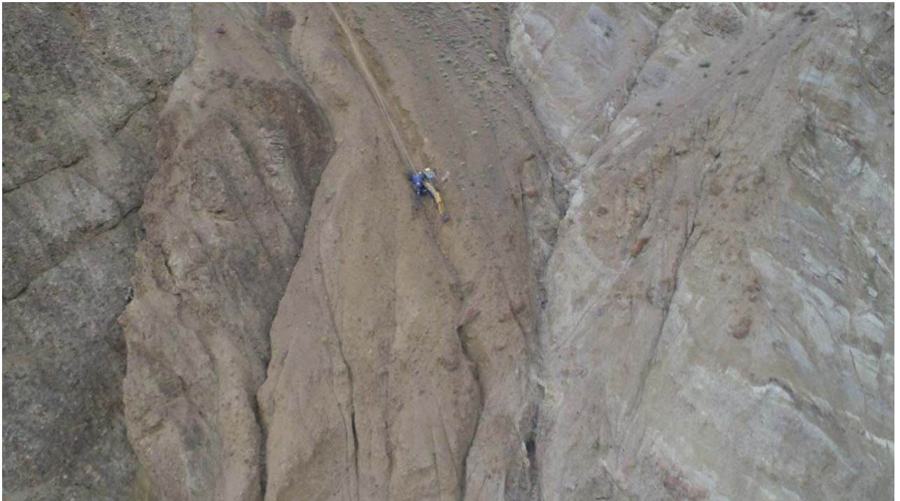
Figure 2 – Excavatrice à pattes descendant les pentes raides au moyen d'un treuil de boteur télécommandé
