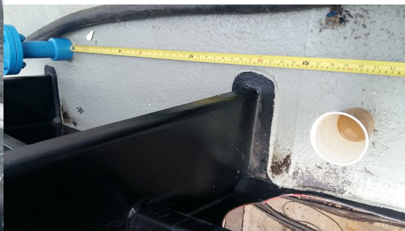
Figure 1: Distance entre l'évent et la fin du réservoir. tel que vu sur le pont principal
