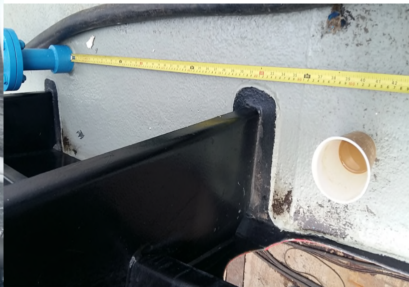
Figure 1: Distance entre l'évent et la fin du réservoir. tel que vu sur le pont principal
