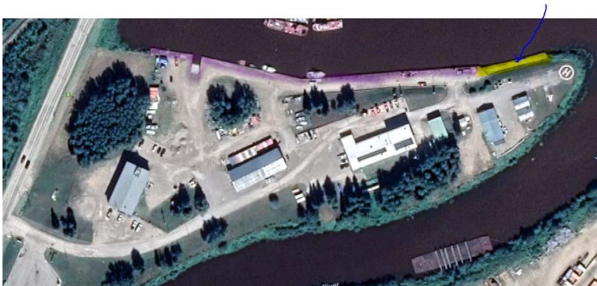
Photo 3 : Quai en palplanches (La partie en violet reste, la partie en jaune doit être réparée)
