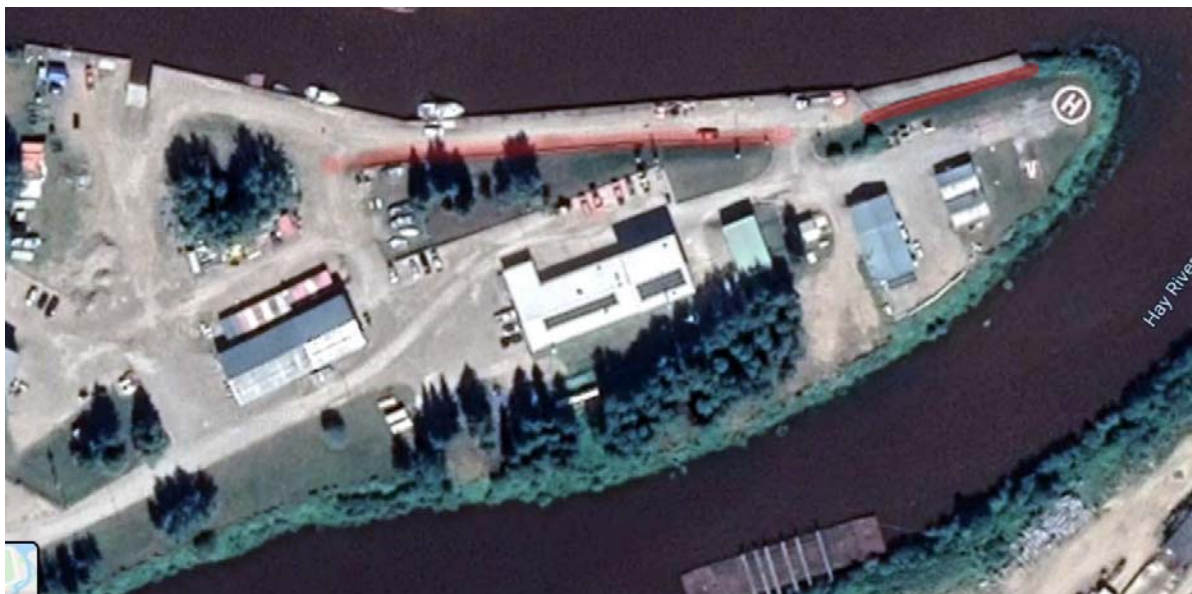
Photo 7 : Murs de soutènement en pieux de bois en mauvais état (surlignés en rouge)
