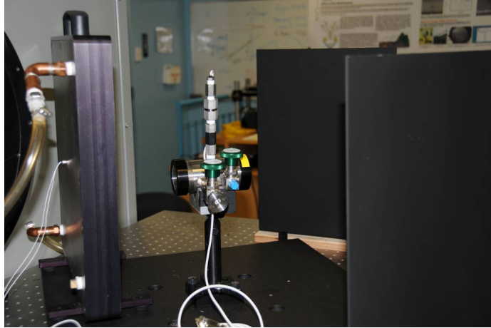
Figure 1 : Montage de laboratoire. À gauche, la plaque à température contrôlée est visible avec les tubes servant à la circulation d'éthylène-glycol et le filage du thermocouple à l'arrière. Au centre, la cellule de gaz en acier inoxydable contient l'échantillon. Les ouvertures permettent la vidange et le remplissage de la cellule ; un thermocouple mesure la température à l'intérieur. Sur la droite, des plaques d'aluminium peintes permettent de cacher la cellule au capteur testé.
