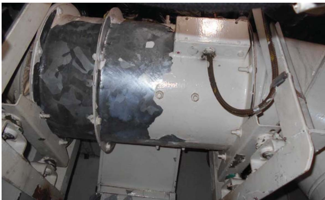
Figure 14: Photographie du ventilateur axial d'alimentation du pont de gaillard
