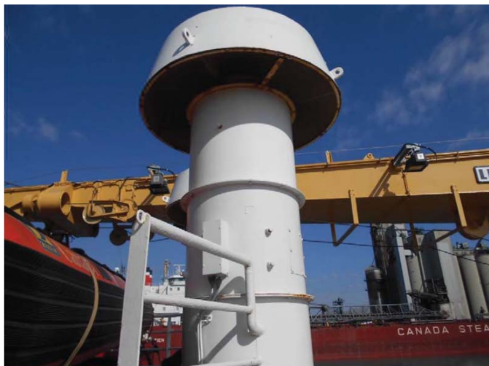
Figure 6: Photographie du ventilateur d'alimentation dans la salle des machines
