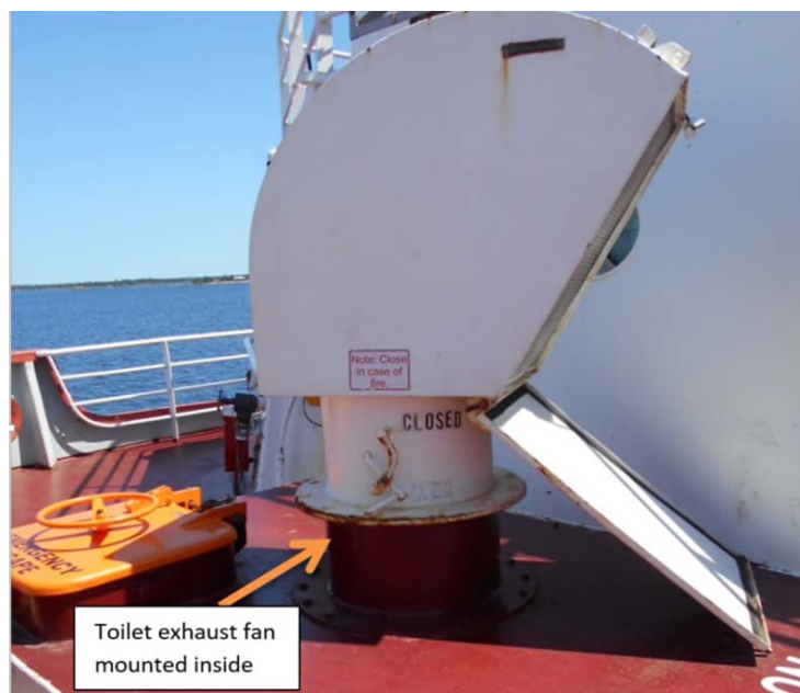
Figure 22: Photographie des ventilateurs axiaux d'évacuation des toilettes
