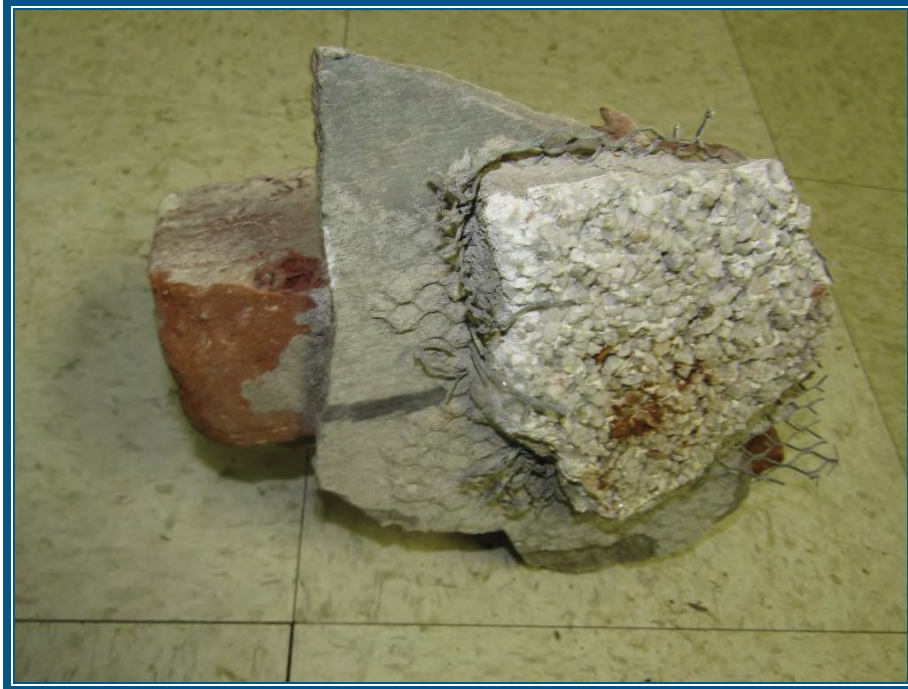
Photo 63: Matériaux fournis par Parcs Canada prélevé lors des travaux de rénovation sur les murs extérieurs. La phase « fini décoratif » de ce matériau contient de l'amiante
