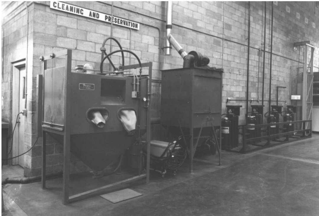
Figure 14-32 Grit Blast Cabinet Figure 14-32 Décapeuse à abrasifs
