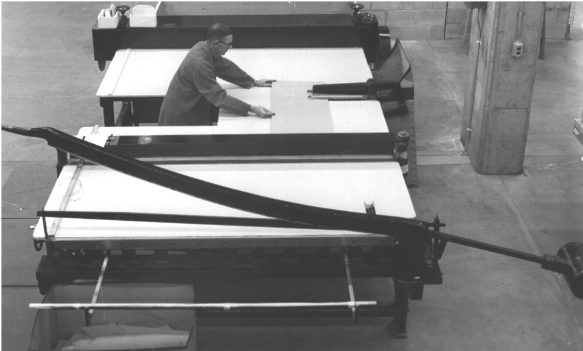
Figure 14-22 Carton Forming Machine Figure 14-22 Machine à façonner des boîtes de carton
