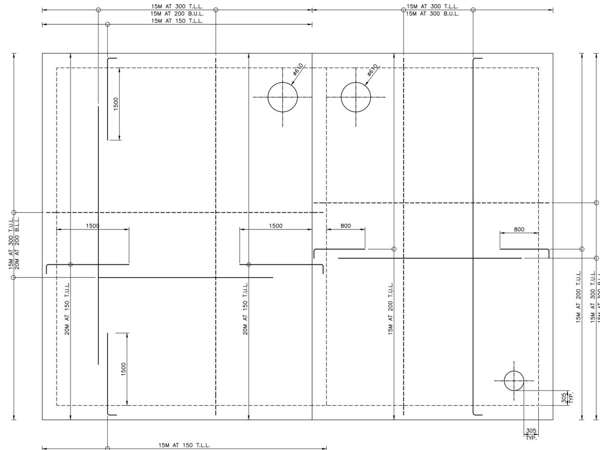
**PLAN - SUSPENDED SLAB REINFORCING**
