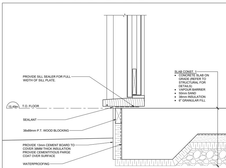
**DOOR SILL AT SLAB DETAIL**
