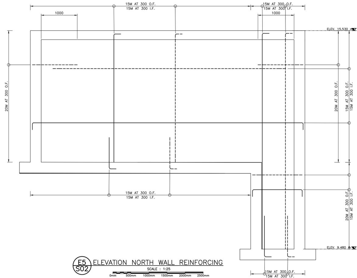
**E5** ELEVATION NORTH WALL REINFORCING
