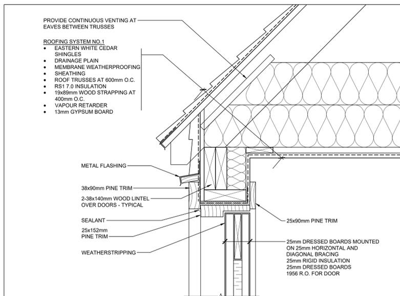
**DOOR AT SOFFIT DETAIL**
