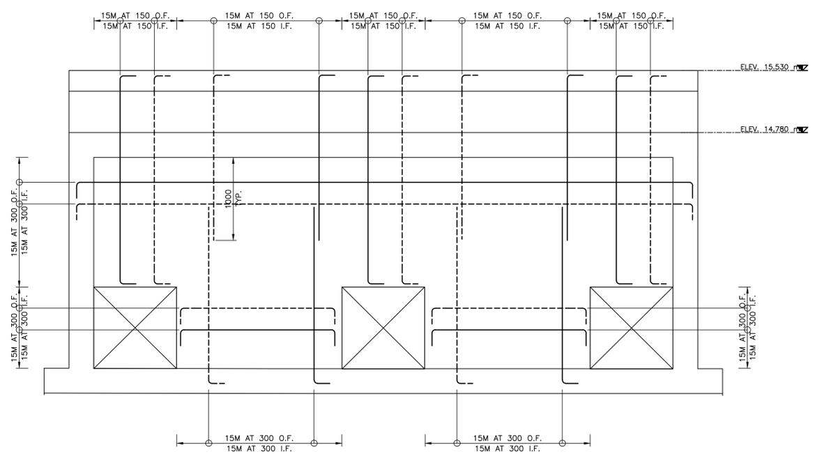
**E4** ELEVATION INTERIOR WALL REINFORCING
