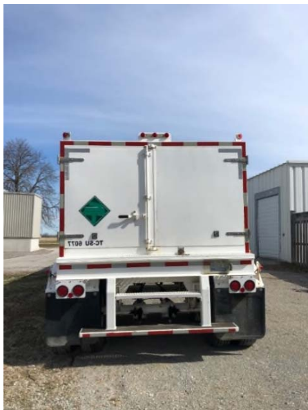
Remorque de tubes, armoire fermée
