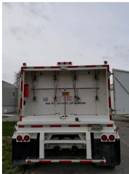
Remorque de tubes, armoire ouverte
