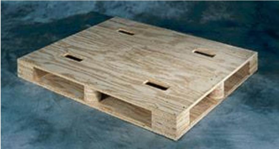
Palette # 2 : Contreplaqué Bloc de palettes (Double face, entrée à quatre voies, réversible)
