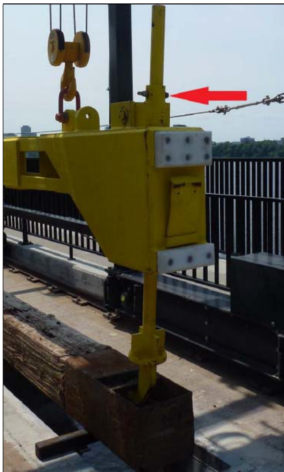
Figure 13 : Palonnier. La flèche montre le boulon qui doit être changé chaque année
