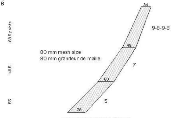
5 lower wings starboard side 5 ailes inférieures tribord
