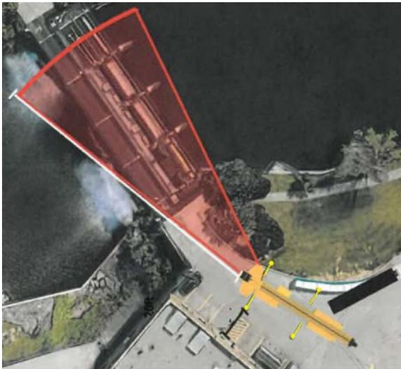
**R7.** : Le problème est que nous n'avons aucune information sur la construction du mur qui passe sous les places de stationnement devant la centrale de chauffage, ni sur la dalle qui constitue le toit de ce sous-sol étendu. Donc, nous n'avons donc aucun moyen d'évaluer l'effet de la charge des stabilisateurs sur la structure, et c'est la raison de l'exigence de la distance de recul. Nous ne pouvons pas la changer.
