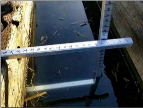
Image 5. Un dispositif de mesure à distance donne l'élévation et la distance horizontale de la coque par rapport à la bordure du tablier de béton.
