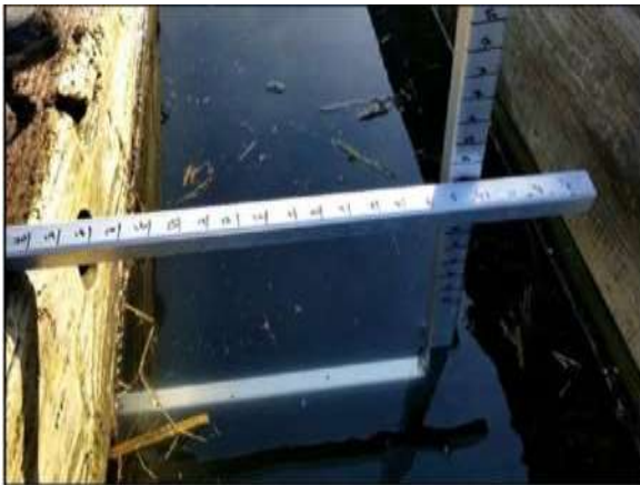
Image 5. Un dispositif de mesure à distance donne l'élévation et la distance horizontale de la coque par rapport à la bordure du tablier de béton.
