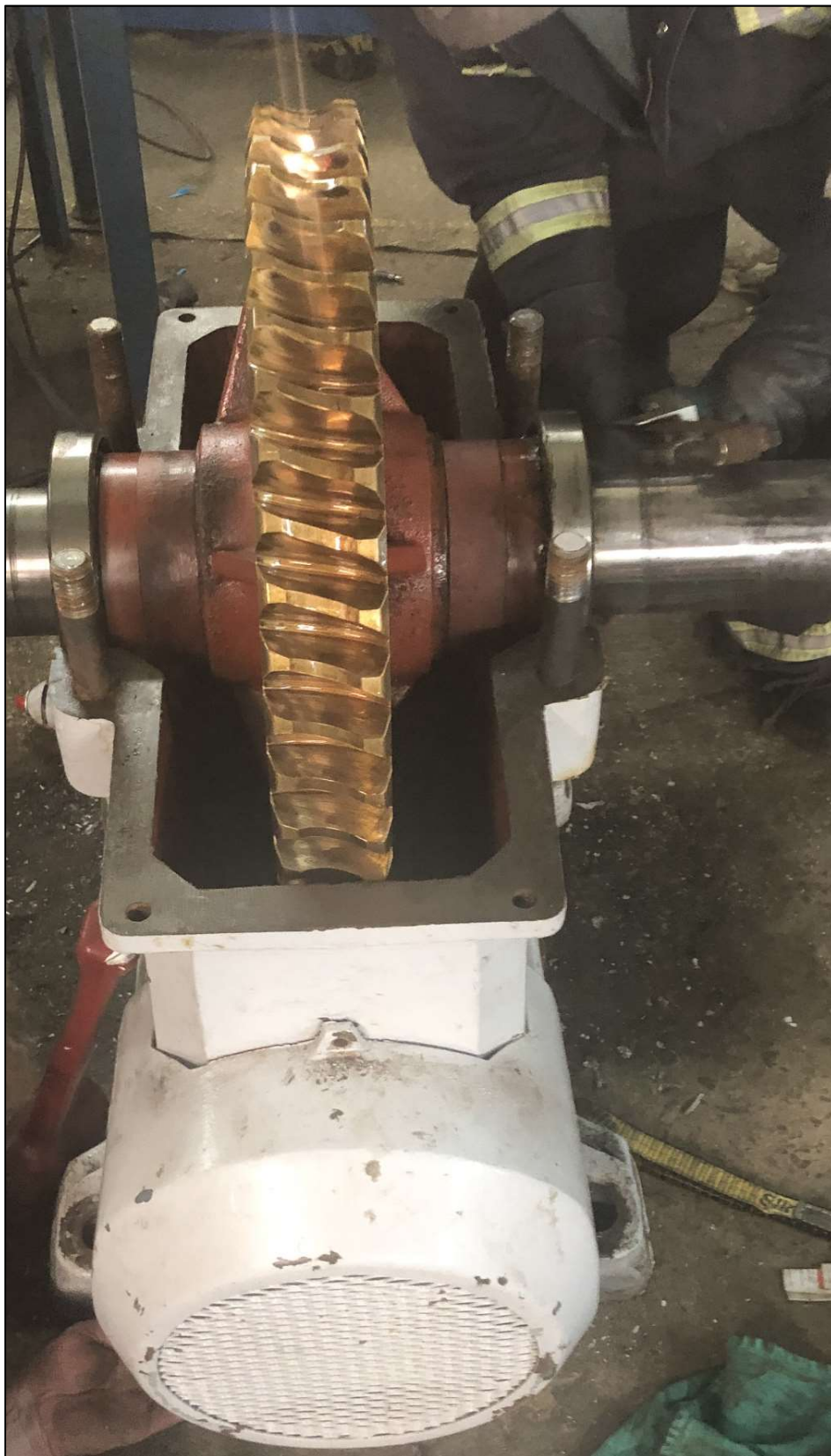
Figure 12: Photo prise lors de travaux antérieurs de la révision de la grue à cadre principale.
