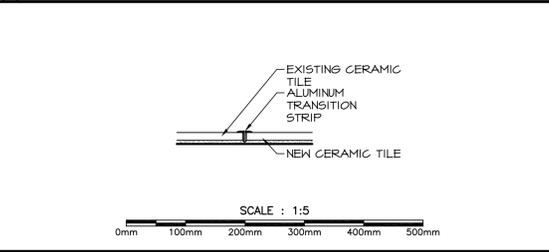
11 TYPICAL CERAMIC TILE FLOOR TRANSITION SCALE 1:5
