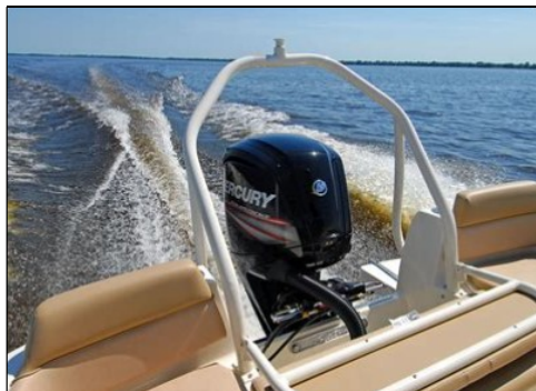
Figure 8 - Exemple de la configuration générale souhaitée de la barre de remorquage.
