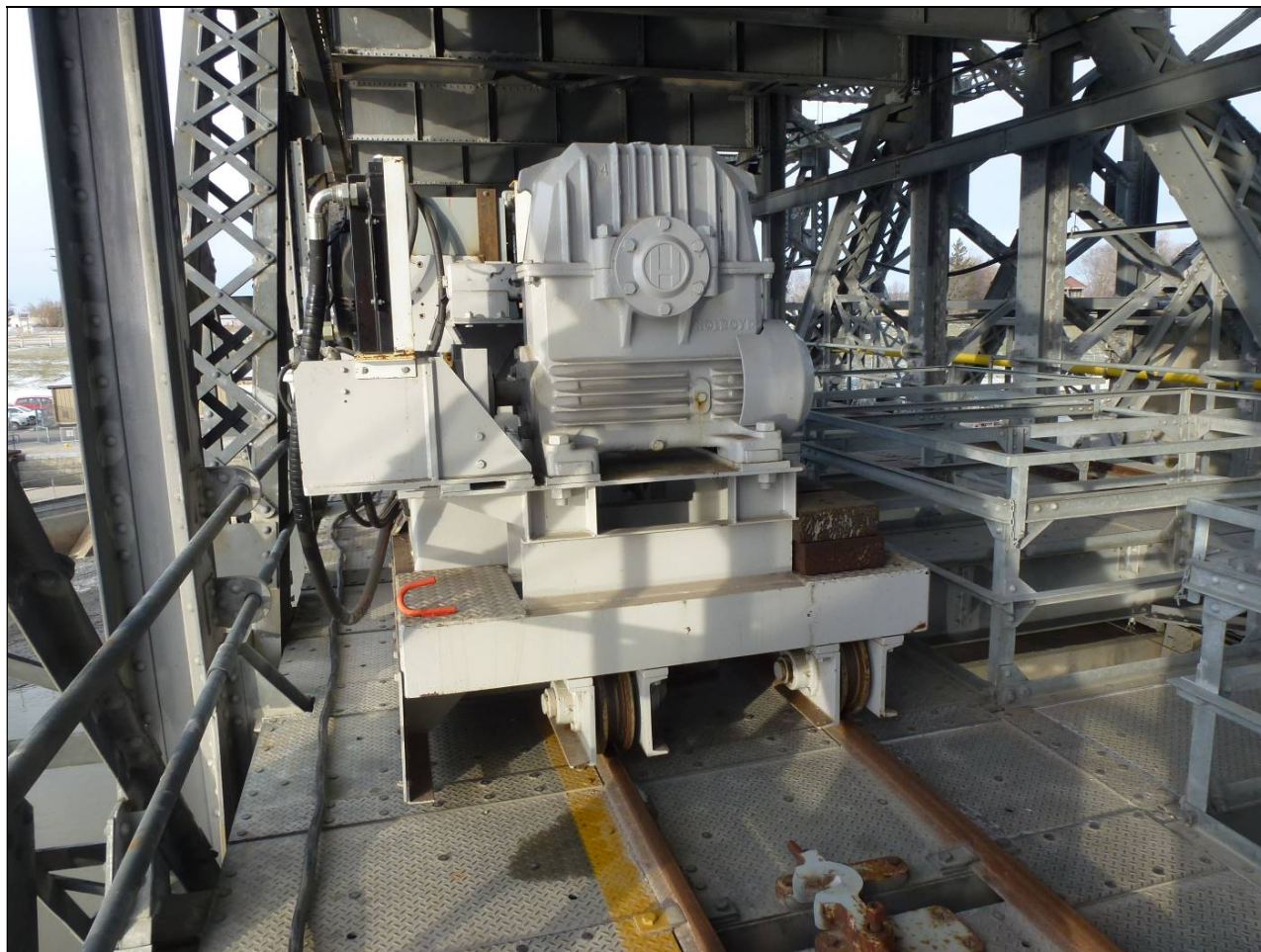
Figure 11 : Grue à cadres principale sur le tablier opérationnel, vue en bout.
