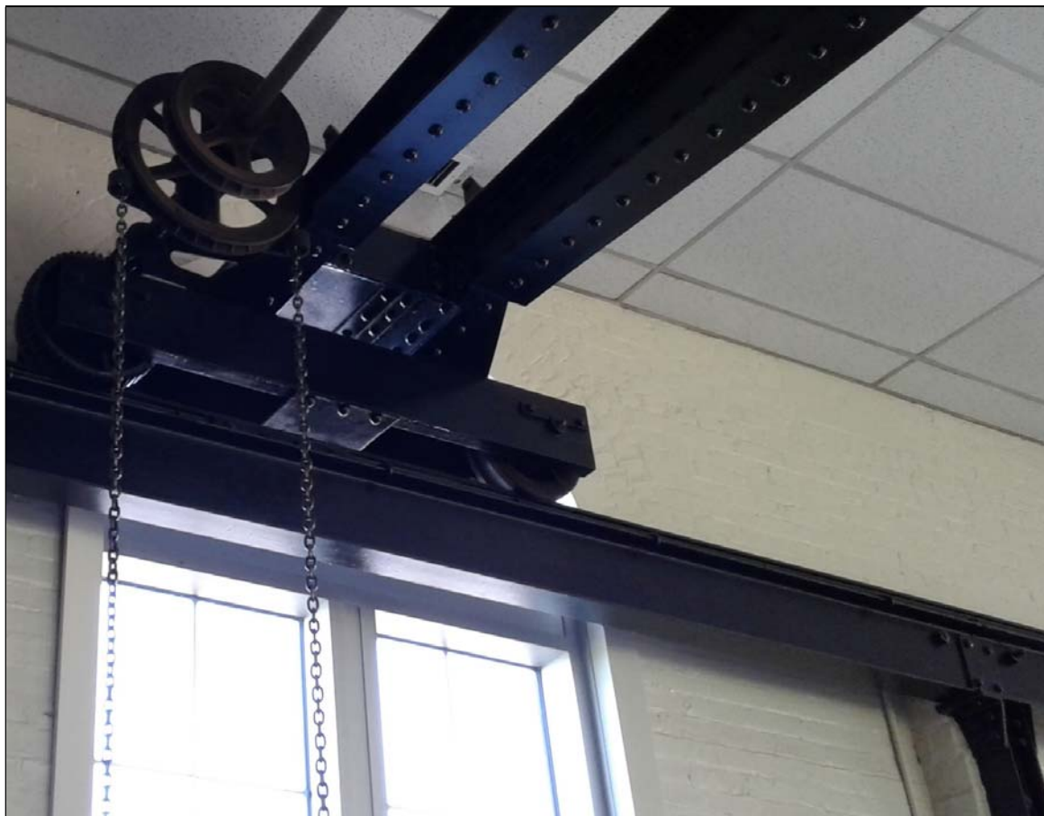
Figure 35 : Pont roulant dans l'atelier de menuiserie, détail du sommier
