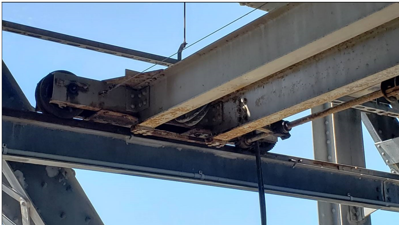
Figure 25 : Pont roulant bipoutre sur le tablier opérationnel, détail du sommier.
