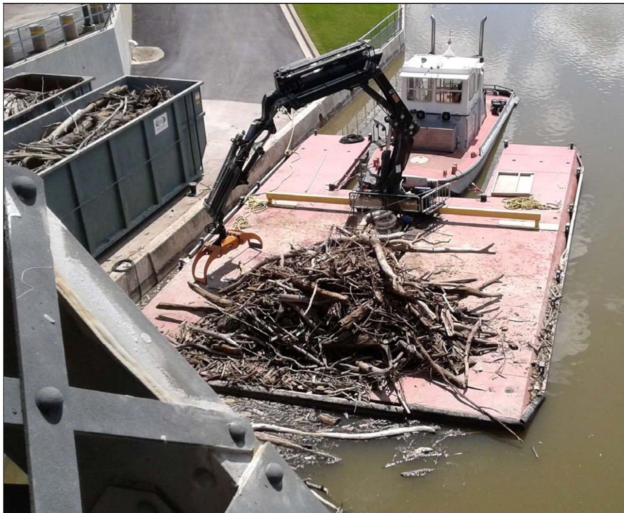
Figure 36 : Grue articulée HIAB 288 sur la barge de débris de SPOONBILL. Remorqueur SPOONBILL à l'arrière.
