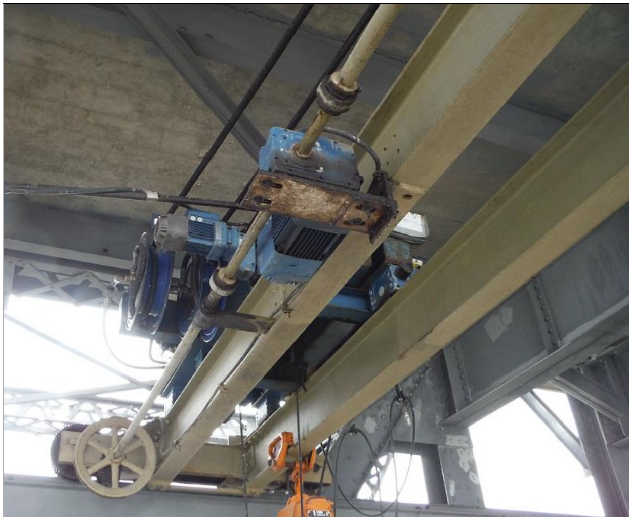
Figure 31 : Pont roulant bipoutre sur le tablier opérationnel Détail du sommier et de la face inférieure du treuil de 5 tonnes
