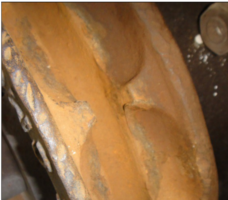
Figure 23 : Grue à rideau, roue dentée usée en 2015.
