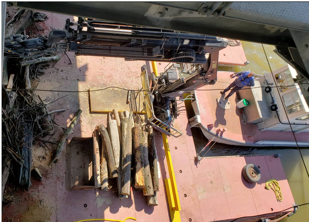
Figure 37 : Autre vue de la grue articulée HIAB 288 sur la barge de débris de SPOONBILL.
