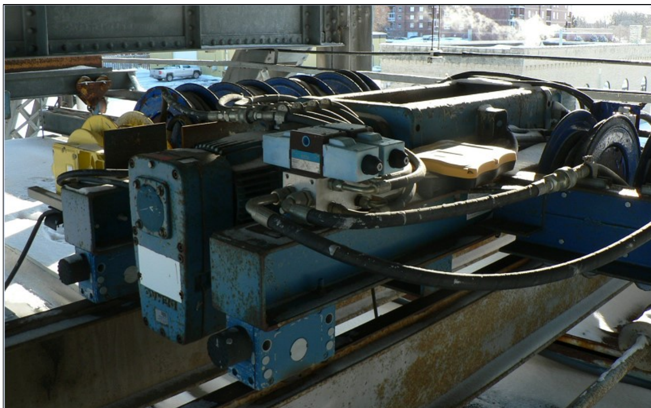
Figure 28 : Pont roulant bipoutre sur le tablier opérationnel, détail du treuil de 5 tonnes.
