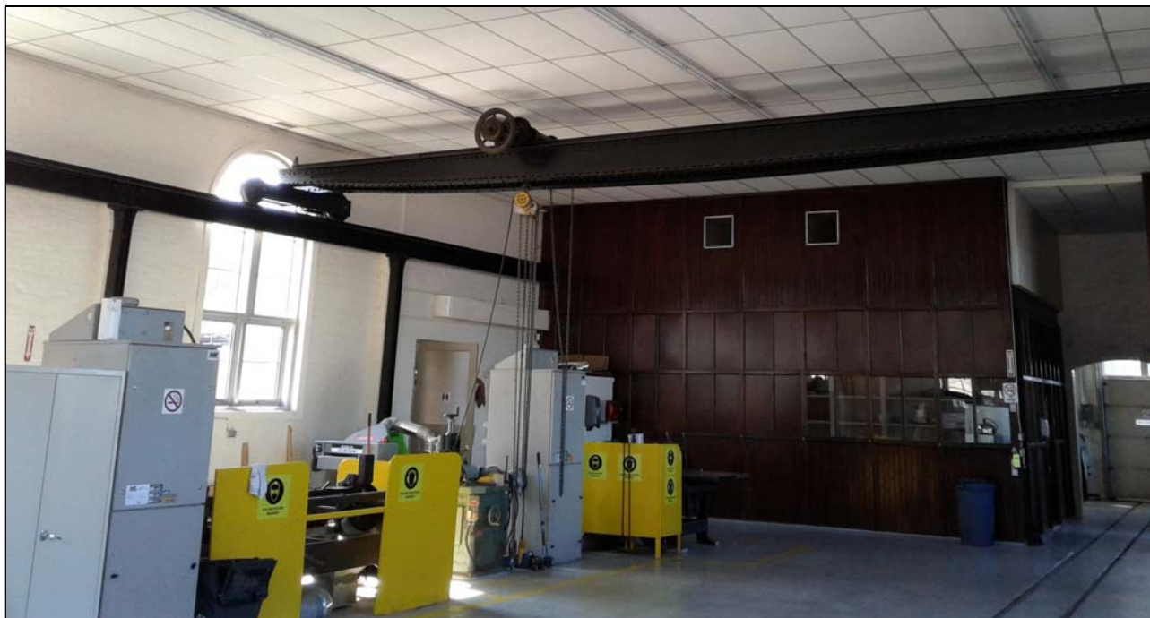
Figure 34 : Pont roulant dans l'atelier de menuiserie, illustrant le treuil à chaîne électrique
