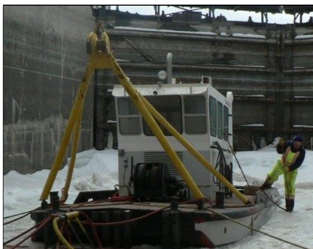
Figure 39 : Treuil monté sur le pont du remorqueur EMBARRAS
