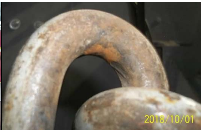
Figure 14 : Grues à cadres, chaîne de levage, état type (tiré du rapport d'inspection générale de 2018).
