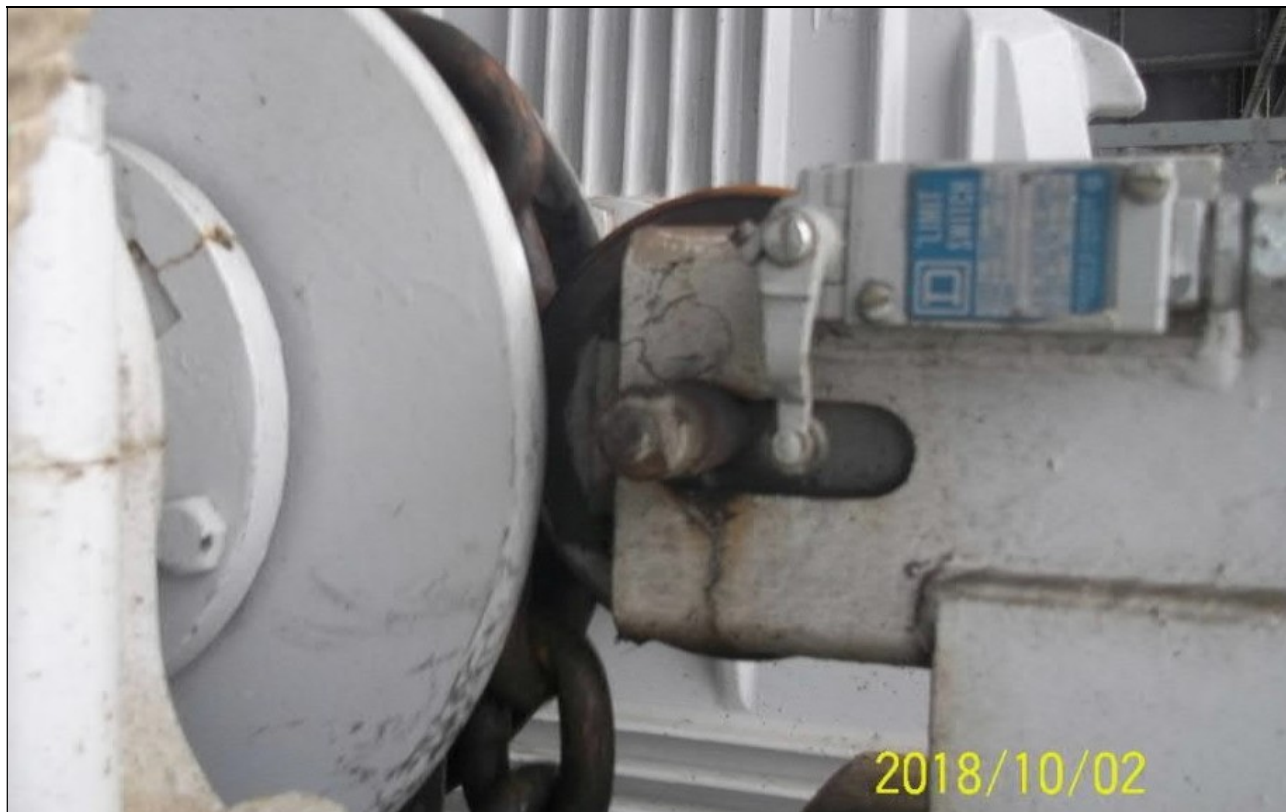
Figure 16 : Grues à cadres, interrupteur de fin de course dont on ignore la fonction.
