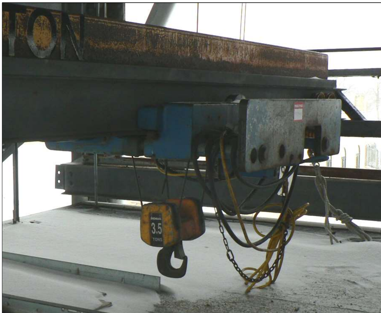
Figure 33 : Pont roulant monopoutre sur le tablier opérationnel, détail du treuil de 3,5 tonnes.
