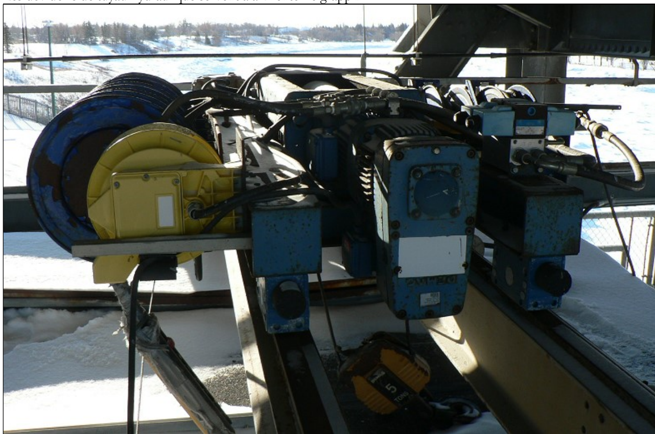
Figure 27 : Pont roulant bipoutre sur le tablier opérationnel, détail du treuil de 5 tonnes.
