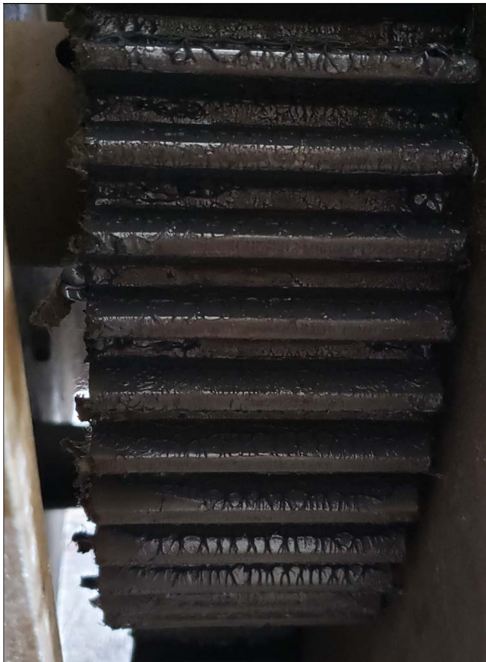
Figure 21 : Grue à rideau, détail de la roue droite cylindrique
