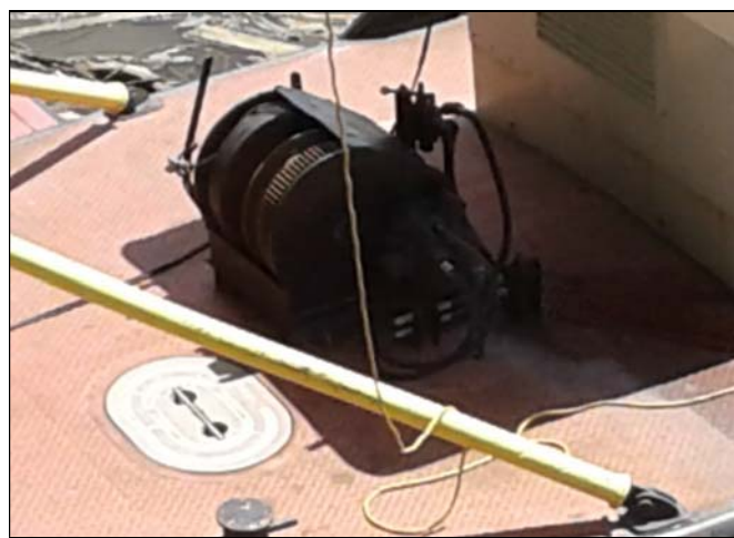
Figure 40 : Treuil monté sur le pont du remorqueur EMBARRAS, détail
