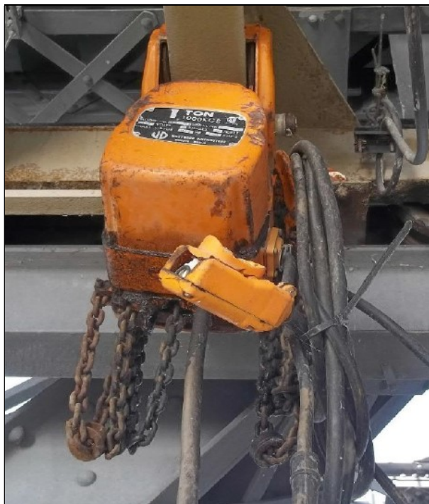
Figure 30 : Pont roulant bipoutre sur le tablier opérationnel, détail du treuil à chaîne de 1 tonne.
