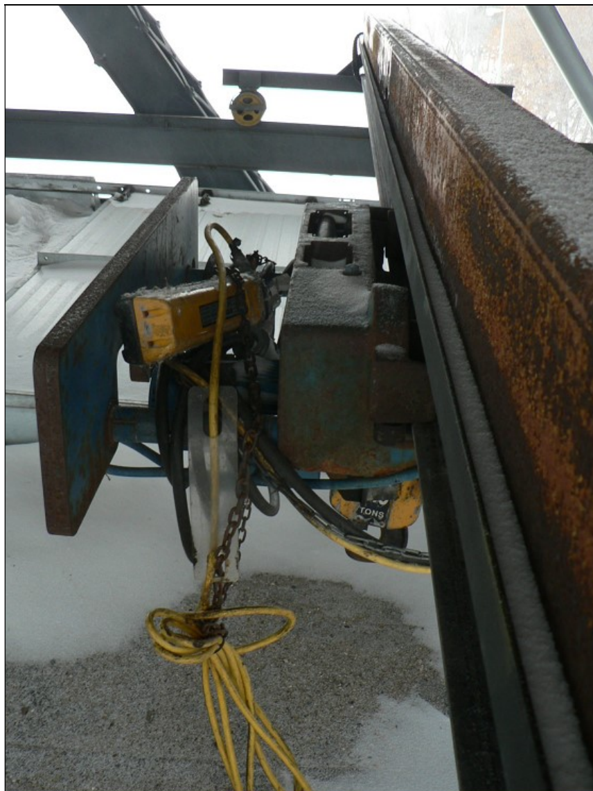
Figure 32 : Pont roulant monopoutre sur le tablier opérationnel, détail du treuil de 3,5 tonnes.
