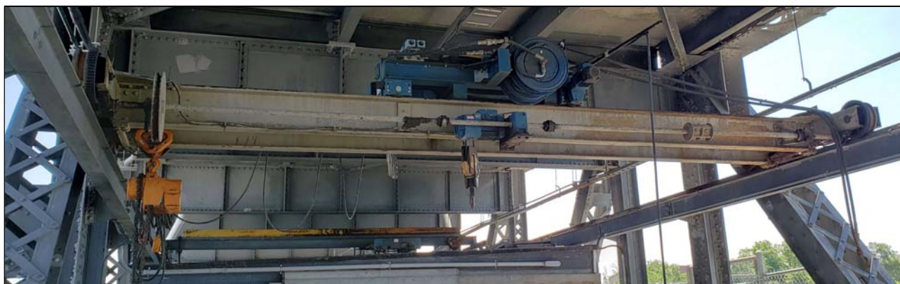
Figure 24 : Pont roulant bipoutre sur le tablier opérationnel, illustrant les treuils de 1 tonne et de 5 tonnes. Pont roulant monopoutre visible en arrière-plan sur la photo.
