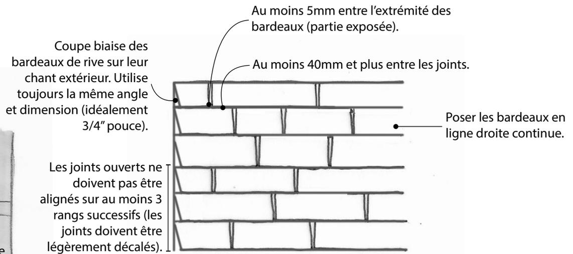
**plan de recouvrement des bardeaux**
