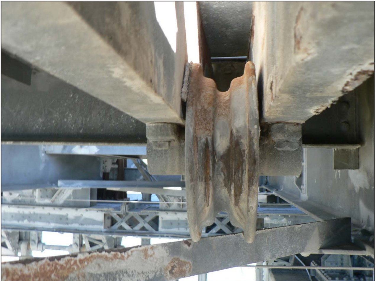
Figure 2 : Pulley (chain guide) for frame crane. / / / Poulie (guide de chaîne) pour la grue à cadres
