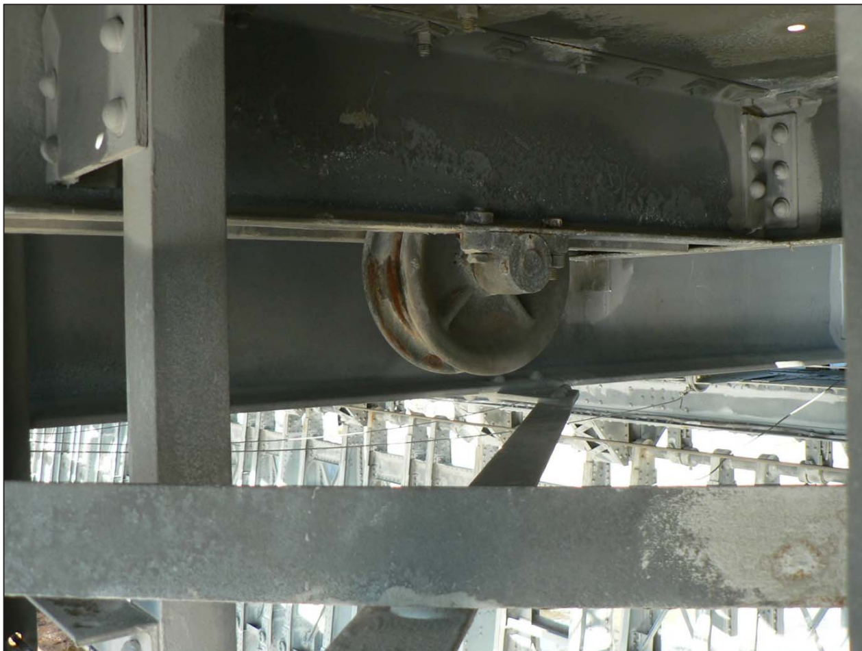
Figure 1: Pulley (chain guide) for frame crane. / / / Poulie (guide de chaîne) pour la grue à cadres.
