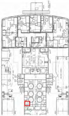
120 Tuyauterie Échappement — Incinérateur — Irrégulière et rectiligne — Canevas et pâte cimentaire et magnésie — 22 po. — 0 m. lin. — Embarcations — Salle des machines — 409 — Pastille 34 Alexandre.Caza - 2017-06-30 09:13
