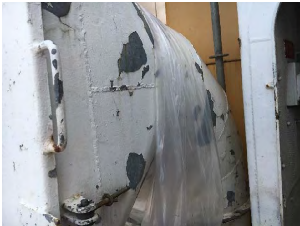
Photo 2 Peinture blanche en mauvais état à l'extérieur du navire, adjacent au local 319.
