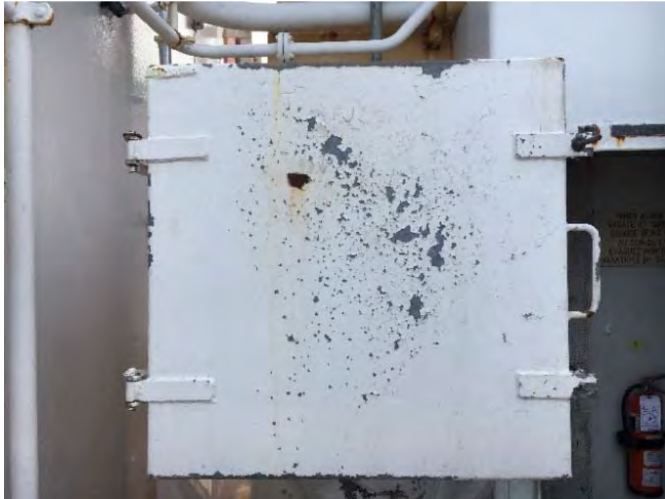
Photo 1 Peinture blanche en mauvais état à l'extérieur du navire, adjacent au local 319.
