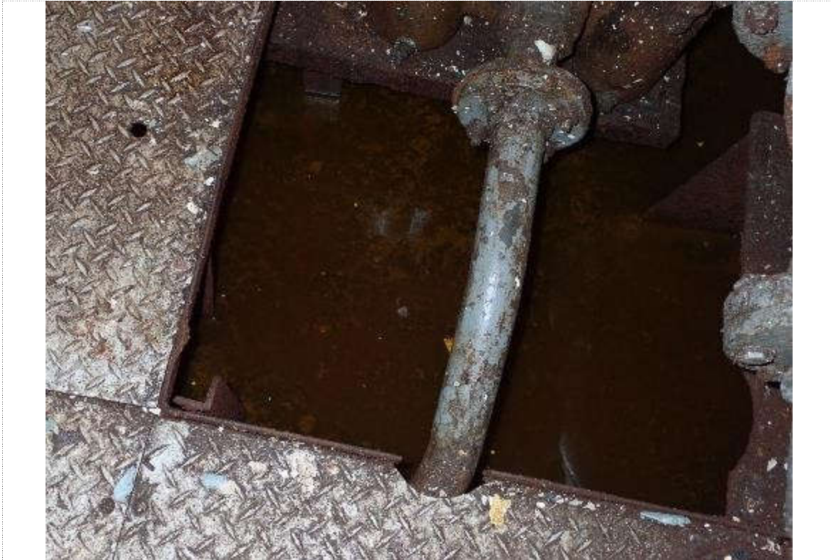
27. Cales de salle de propulsion principale – environ 50 mm d'huile émulsifiée sur l'eau
