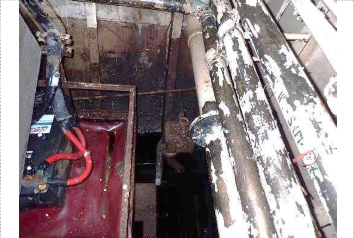
21. Sentine du compartiment de génératrice diesel – couche d'huile sur l'eau
