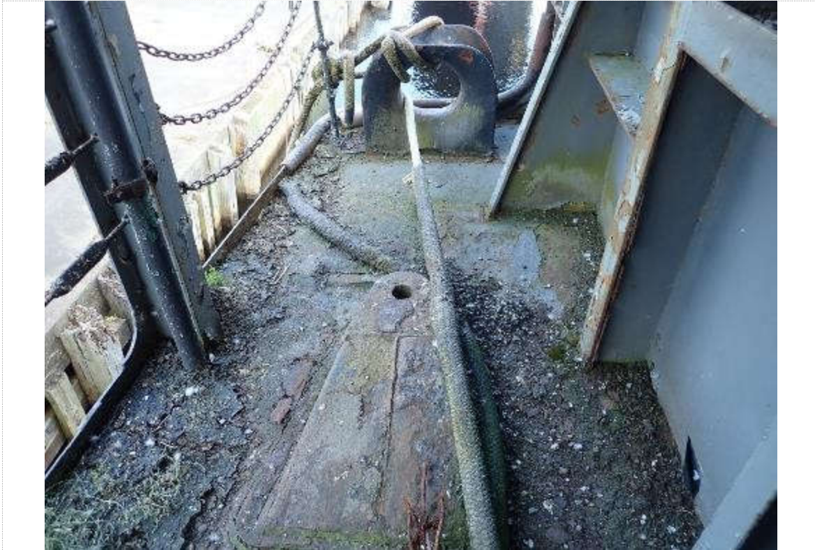
17. Tribord arrière – raccord de remorquage d'urgence
