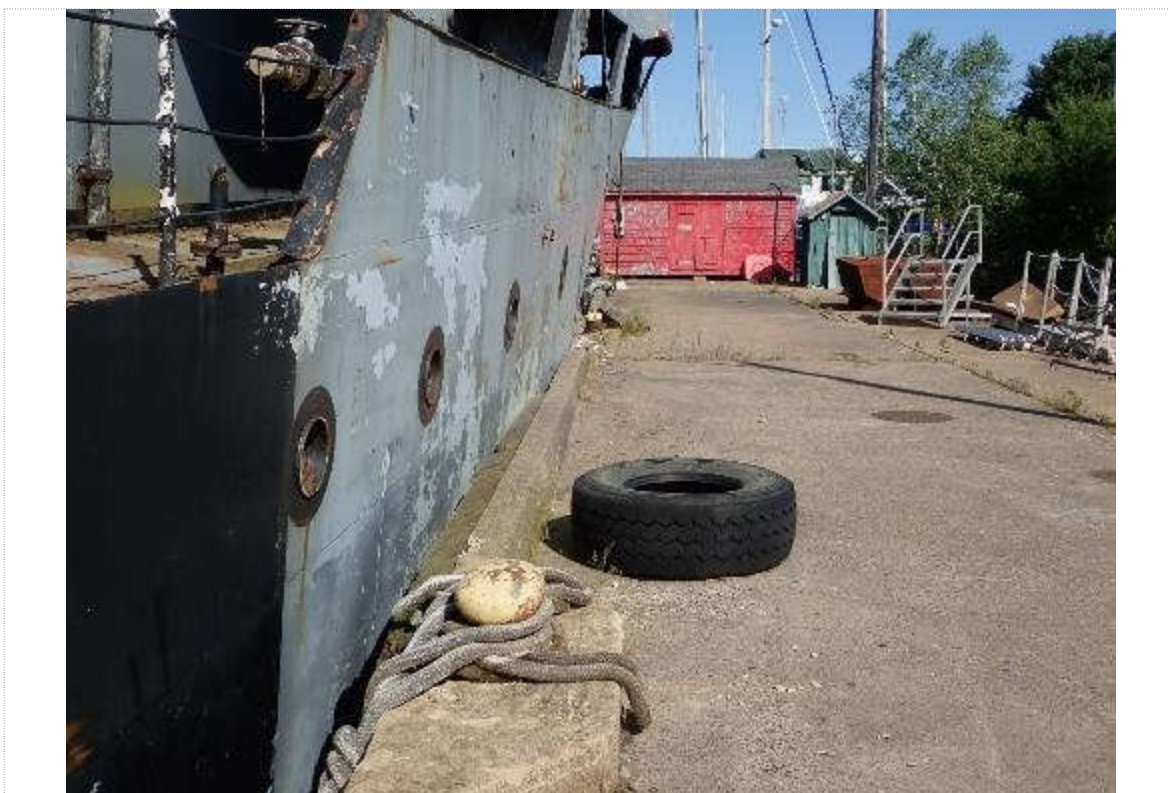
6. Tribord vers l'avant – noter l'état des amarres et les défenses minimales
