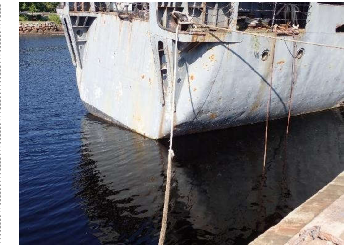
8. Vue au niveau de la poupe – noter le mou dans les amarres
