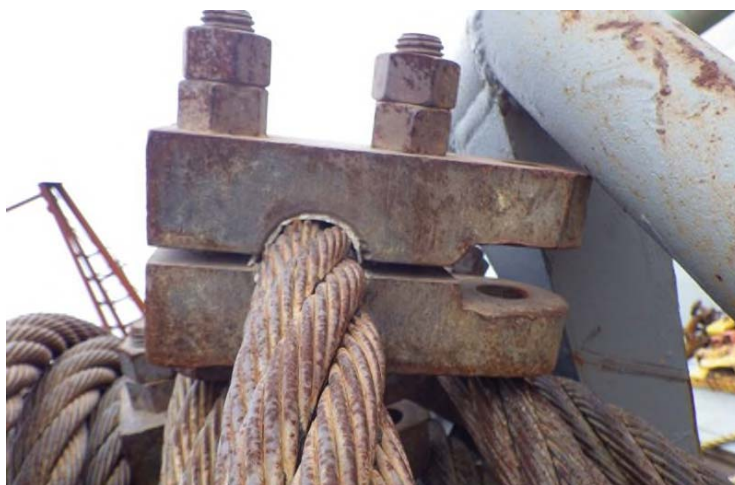
Figure 2: Brides de serrage assemblées sur un câble de section
