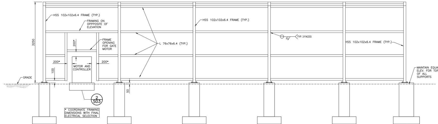
**ELEVATION - CANTILEVERED GATE B ENCLOSURE FRAMING**
