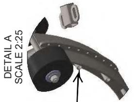
**NOTE 5:** 20 BUMPERS #8 WILL BE NEEDED. THESE WILL BE FITTED TO THE SLEEVES AS SHOWN ON THE DRAWING
