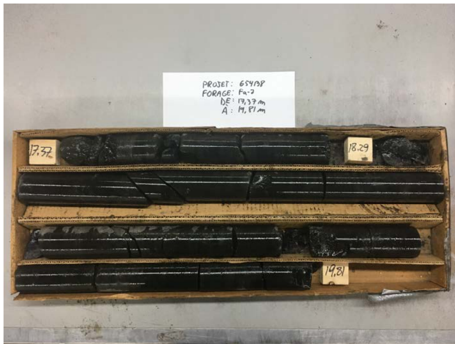
Photo n° 4 : Socle rocheux carotté dans le forage Fa-2 entre 17,90 m et 19,81 m.
