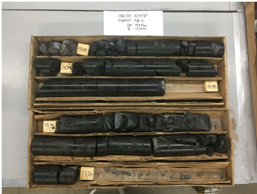
Photo n° 8 : Socle rocheux, cailloux et blocs carottés dans le forage Fb-2 entre 14,48 m et 17,20 m.
