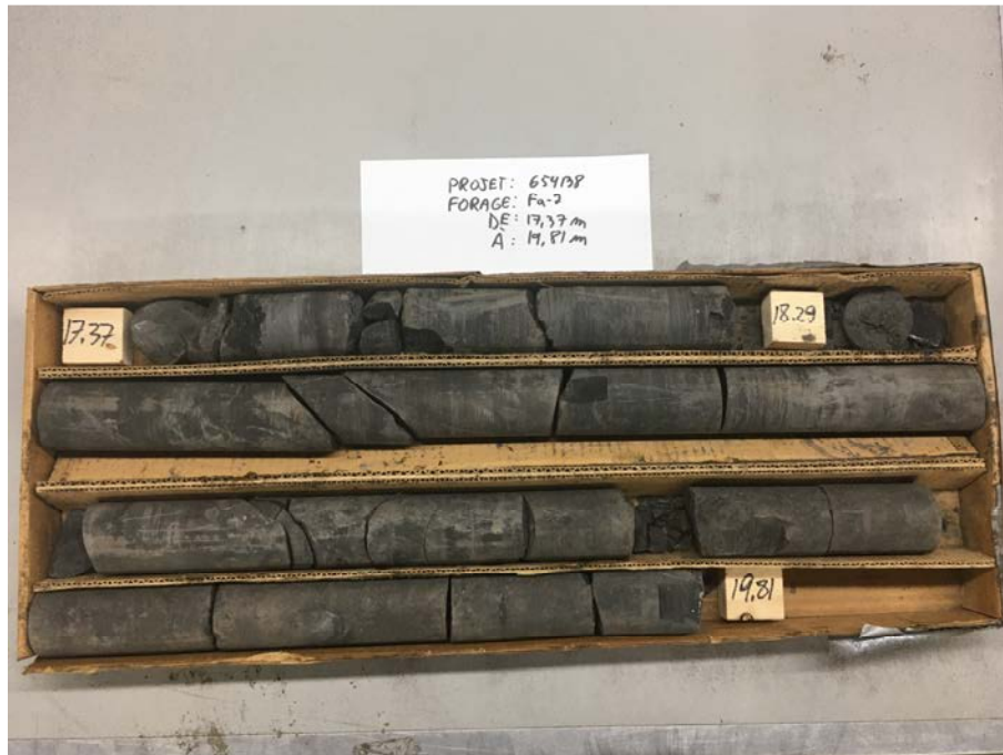
Photo n° 3 : Socle rocheux carotté dans le forage Fa-2 entre 17,90 m et 19,81 m.
