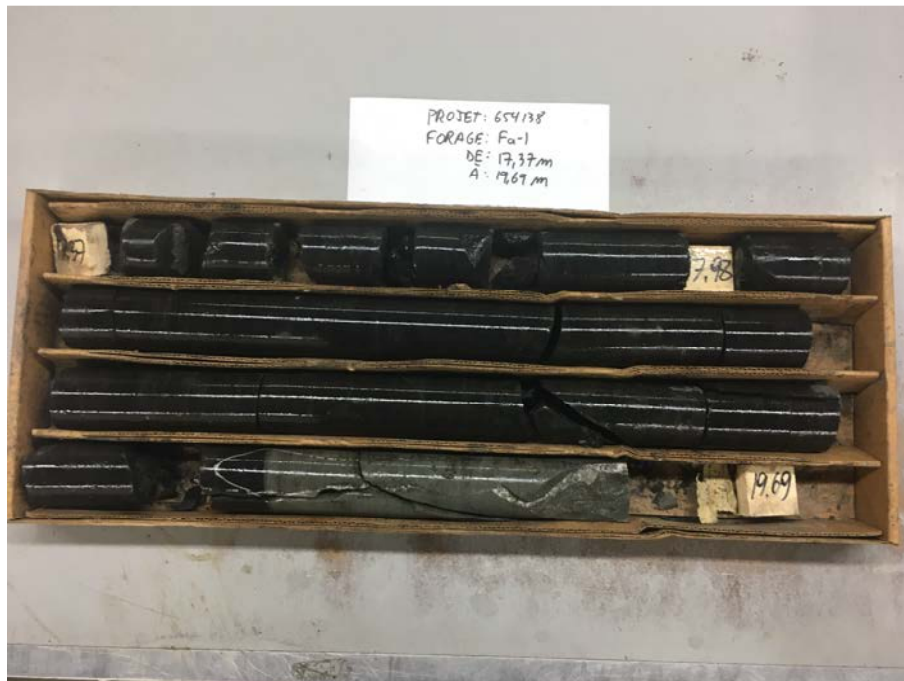
Photo n° 2 : Socle rocheux carotté dans le forage Fa-1 entre 17,66 m et 19,69 m.
