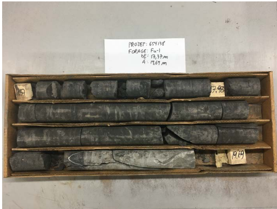
Photo n° 1 : Socle rocheux carotté dans le forage Fa-1 entre 17,66 m et 19,69 m.
