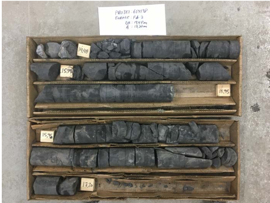
Photo n° 7 : Socle rocheux, cailloux et blocs carottés dans le forage Fb-2 entre 14,48 m et 17,20 m.
