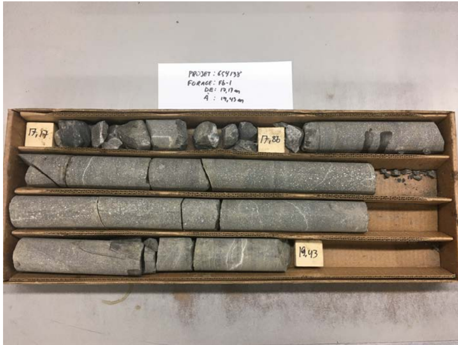
Photo n° 5 : Socle rocheux, cailloux et blocs carottés dans le forage Fb-1 entre 17,17 m et 19,43 m.
