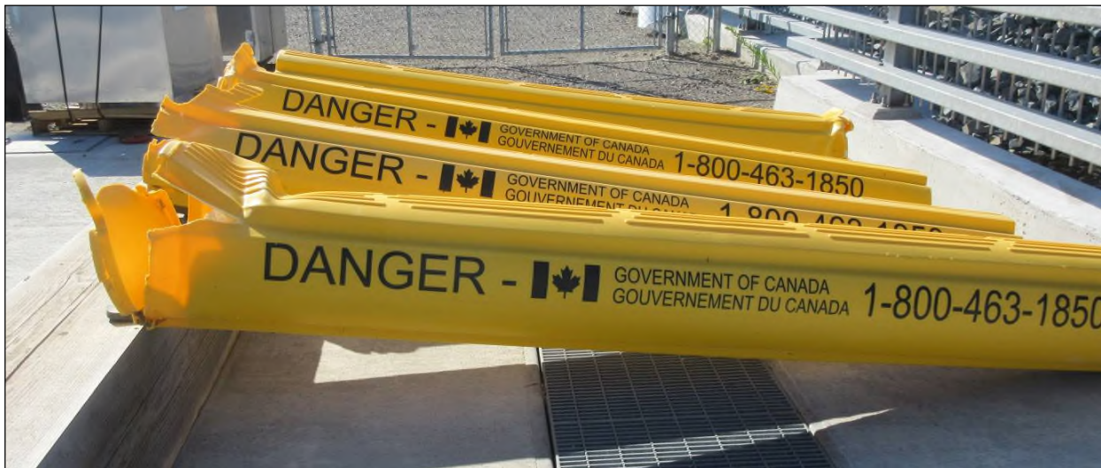
Figure 5 : Gros plan du message d'avertissement et des coordonnées sur la barrière de voie navigable actuelle. Les flotteurs montrés ici sont ceux qui ont été endommagés par la glace.
