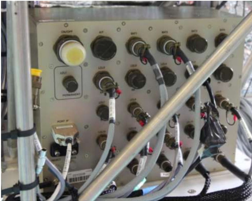
FIGURE 9 PLAN DES CONNECTEURS DU MODULE DE DISTRIBUTION DE COURANT
